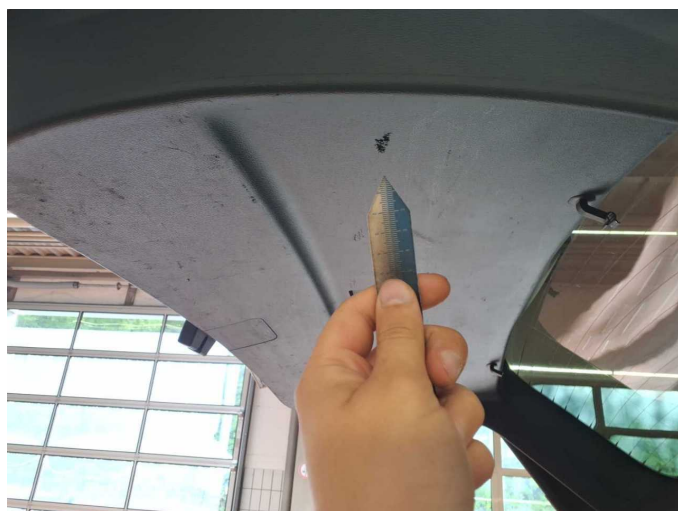
Damage 12: Trim / covers: Boot lid - interior trim (Halierung für Hutablage) - Scratched - Replace
