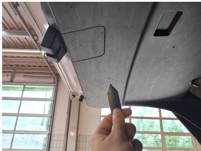
Damage 12: Trim / covers: Boot lid - interior trim (Halterung für Hutablage) - Scratched - Replace
