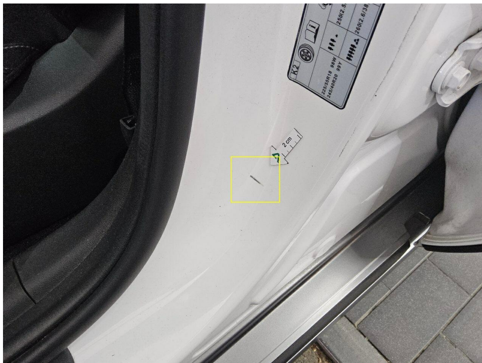
Bild 8 : Tür vorne links Einstieg, zerkratzt
