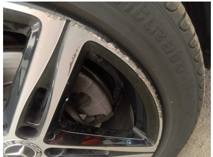
Damage 7: Wheel / tyres: Alloy rim - front right side (Großflächig verkratzt) - Scratch(es) - Replace
