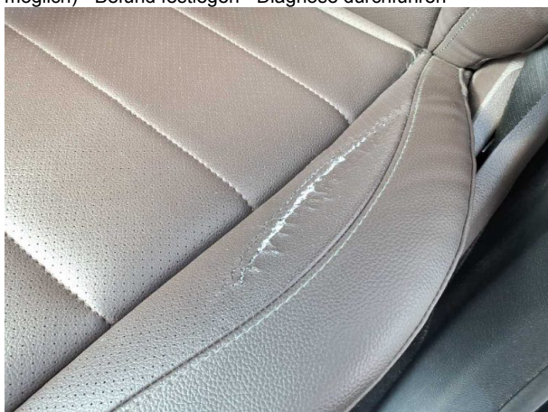
Beschädigung #5: Sitz vorn: Sitzbezug links - gebrochen / gerissen - erneuern
