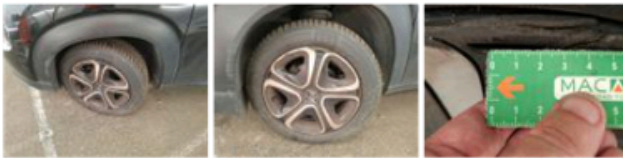
Enjoliveur de roue ARG, Cassé, E - Remplacer
