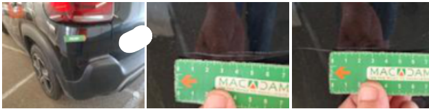
Feu antibrouillard ARD, Cassé, E - Remplacer
