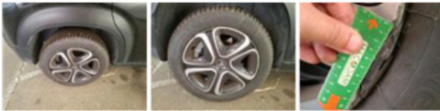
Enjoliveur de roue AVD, Griffé(s), Acceptable
