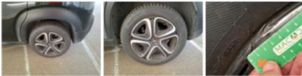
Enjoliveur de roue ARD, Cassé, E - Remplacer
