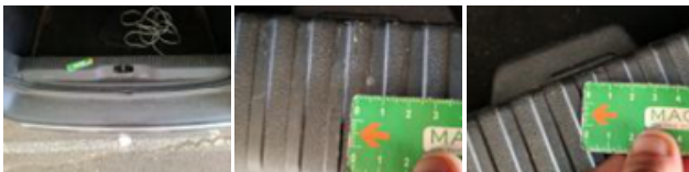
Joint de coffre, Déchirure, E - Remplacer
