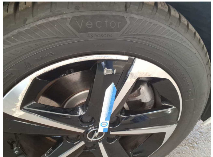
Damage 1: Wheel / tyres: Alloy rim - front right side (Großflächig verkratzt) - Scratched - Replace
