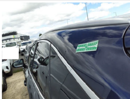
Montant de pavillon / Gauche / Enfoncement grêle
