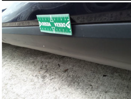
Baguette de porte / Arrière Gauche / Rayure
