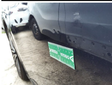
Porte / Avant Gauche / Enfoncement grêle
