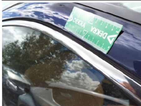
Joint de vitre / Avant Droit / Enfoncement grêle
