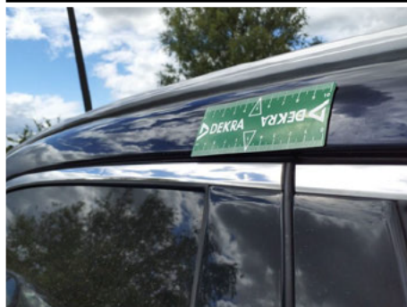
Joint de vitre / Arrière Droit / Enfoncement grêle
