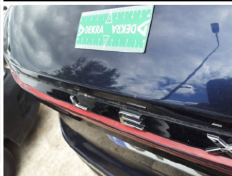
Hayon / Porte de coffre / - / Enfoncement grêle
