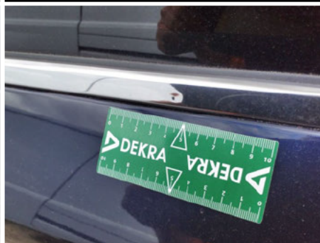
Lêche vitre / Arrière Gauche / Enfoncement grêle
