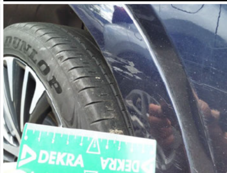
Extension porte / Arrière Droit / Rayure
