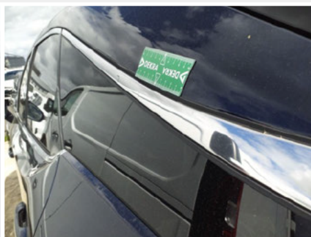
Enjoliveur glace de custode / Arrière Gauche / Enfoncement grêle
