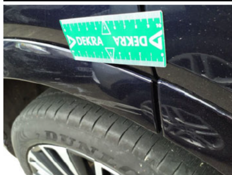
Extension d'aile / Arrière Droit / Rayure
