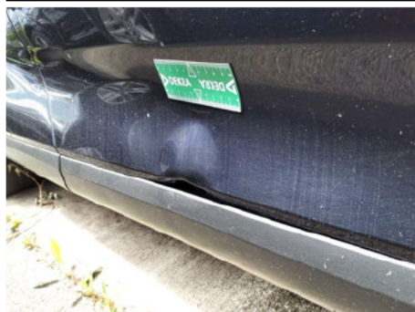
Porte / Avant Droit / Enfoncement
