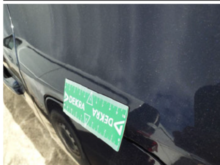
Alle / Arrière Gauche / Enfoncement grêle
