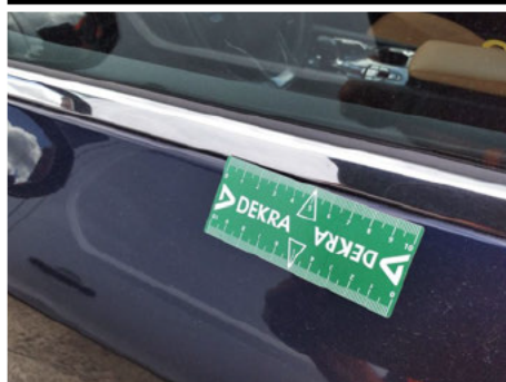
Lêche vitre / Avant Gauche / Enfoncement grêle
