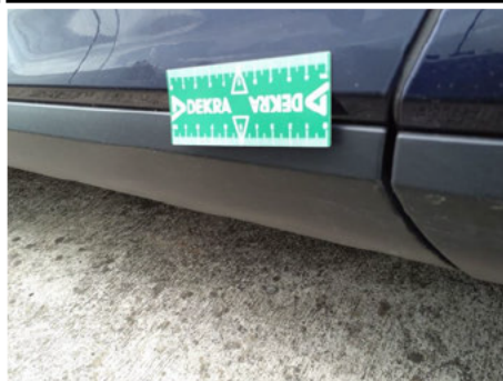
Baguette de porte / Avant Gauche / Rayure
