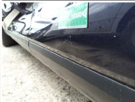
Porte / Arrière Gauche / Enfoncement
