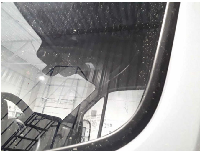
Beschädigung 14: Verglasung: Türscheibe vorn links - Kratzer - erneuern
