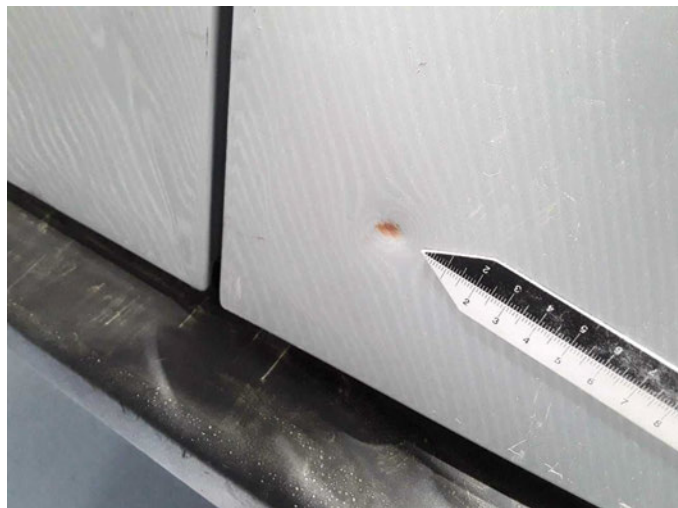
Beschädigung 22: Heckklappe/-tür: Hecktür rechts - verformt - erneuern
