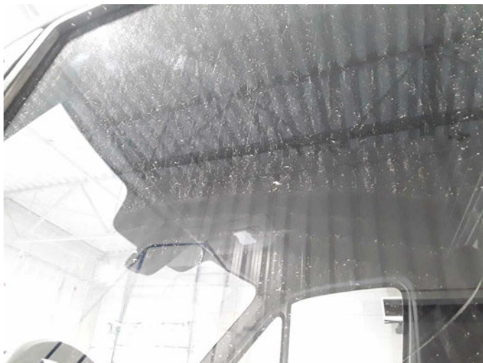
Beschädigung 14: Verglasung: Türscheibe vorn links - Kratzer - erneuern
