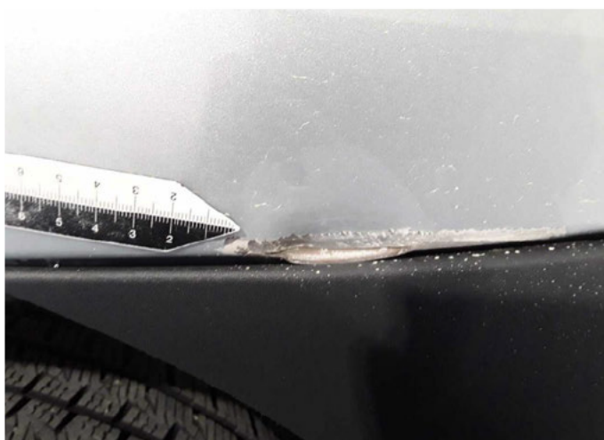
Beschädigung 28: Seitenwand rechts: Seitenwand - gebrochen / gerissen - erneuern
