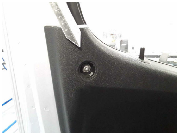
Beschädigung 11: Verkleidungen/Abdeckungen: Türverkleidung vorn links - fehlt - erneuern
