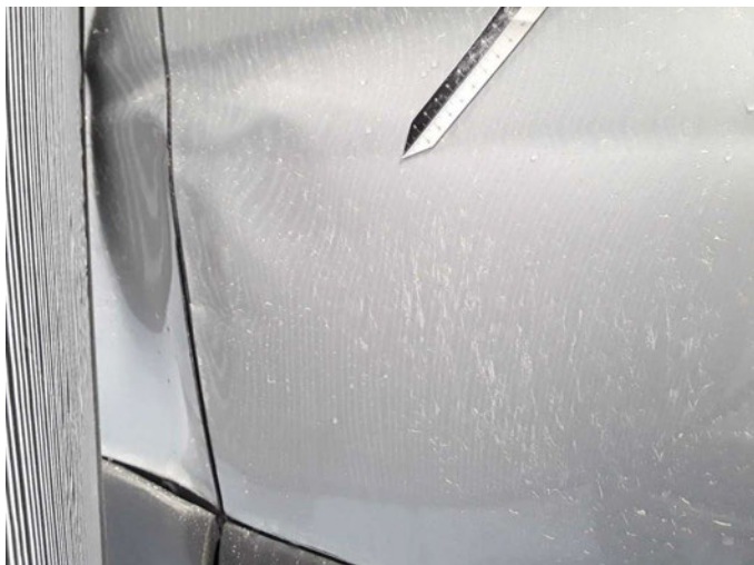
Beschädigung 15: Seitenwand links: Seitenwand - verformt - erneuern
