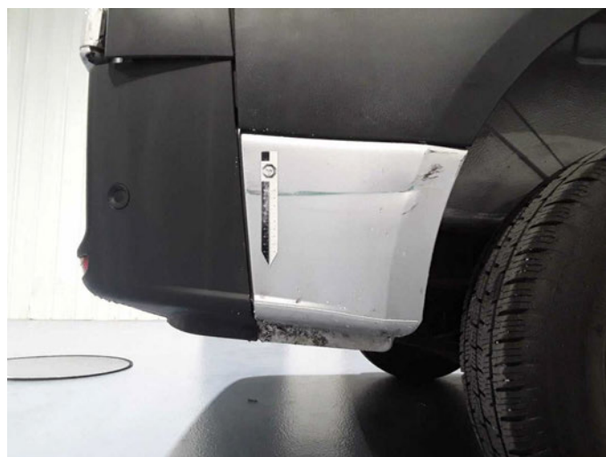
Beschädigung 27: Seitenwand rechts: Radlauf - beschädigt - instandsetzen/lackieren (S3)
