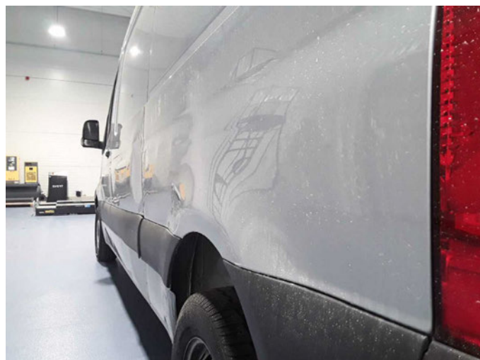
Beschädigung 15: Seitenwand links: Seitenwand - verformt - erneuern
