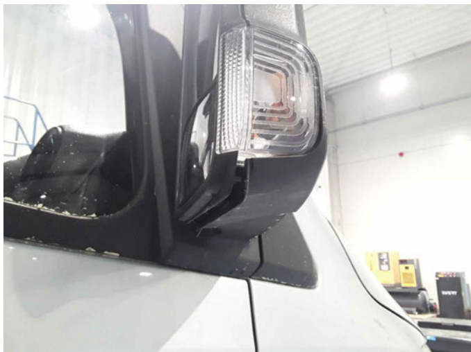
Beschädigung 37: Außenspiegel rechts: Abdeckkappe - beschädigt - erneuern
