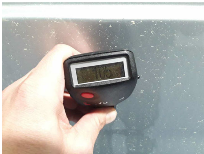
Seitenwand links: 105 \mu\text{m}
