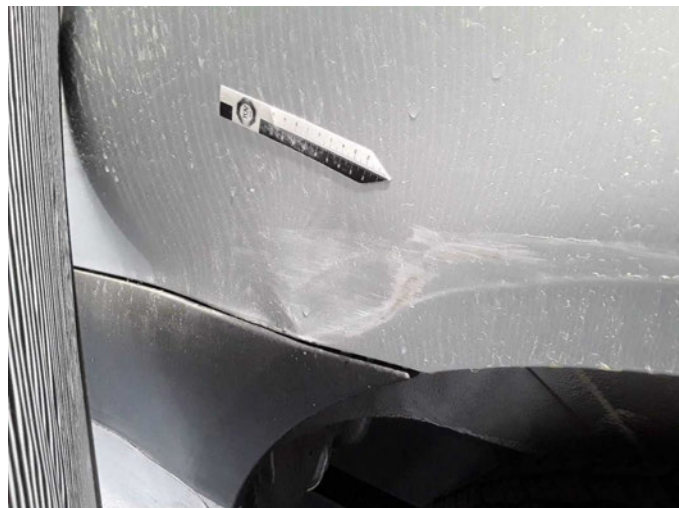
Beschädigung 15: Seitenwand links: Seitenwand - verformt - erneuern
