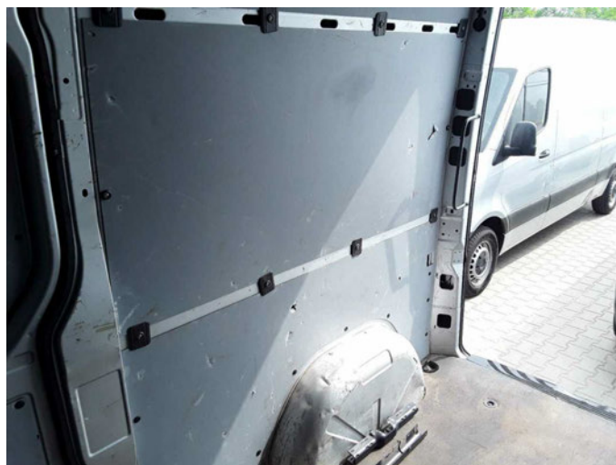
Beschädigung 3: Verkleidungen/Abdeckungen: Laderaumverkleidung rechts - beschädigt - erneuern
