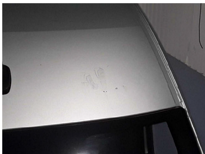
Beschädigung 43: Fahrzeugdach: Dach - beklebt/ beschriftet - entkleben/neutralisieren
