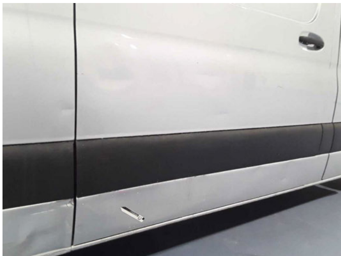
Beschädigung 31: Schiebetür rechts: Schiebetür - verformt - instandsetzen/lackieren (S3)
