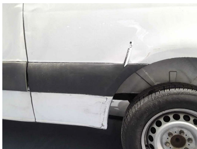
Beschädigung 18: Seitenwand links: Schutzleiste - verkratzt / verschürft - erneuern
