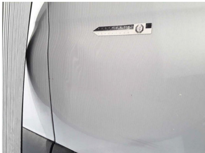
Beschädigung 31: Schiebetür rechts: Schiebetür - verformt - instandsetzen/lackieren (S3)
