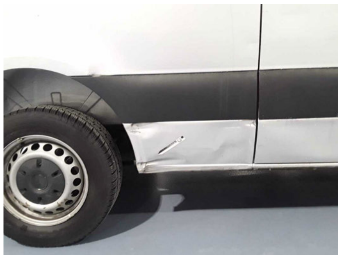
Beschädigung 29: Schweller rechts: Schweller - beschädigt - erneuern
