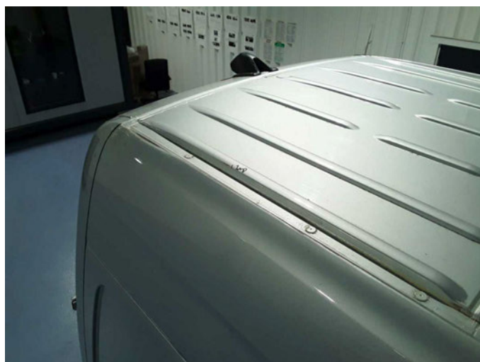
Beschädigung 40: Fahrzeugdach: Dach - verformt - instandsetzen/ lackieren (S3)
