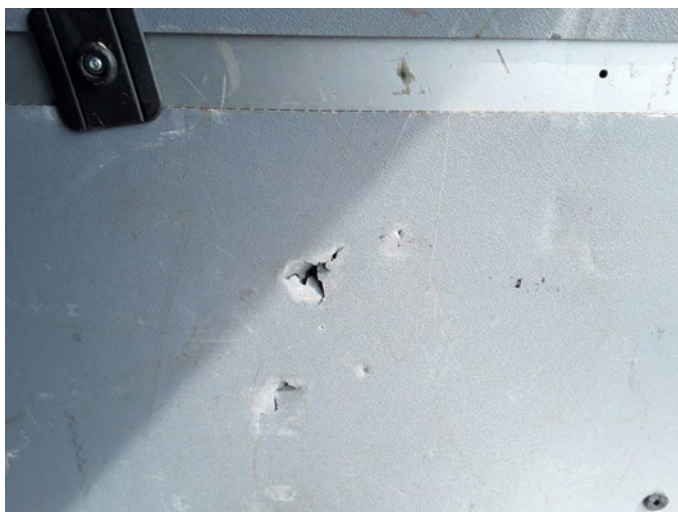
Beschädigung 3: Verkleidungen/Abdeckungen: Laderaumverkleidung rechts - beschädigt - erneuern
