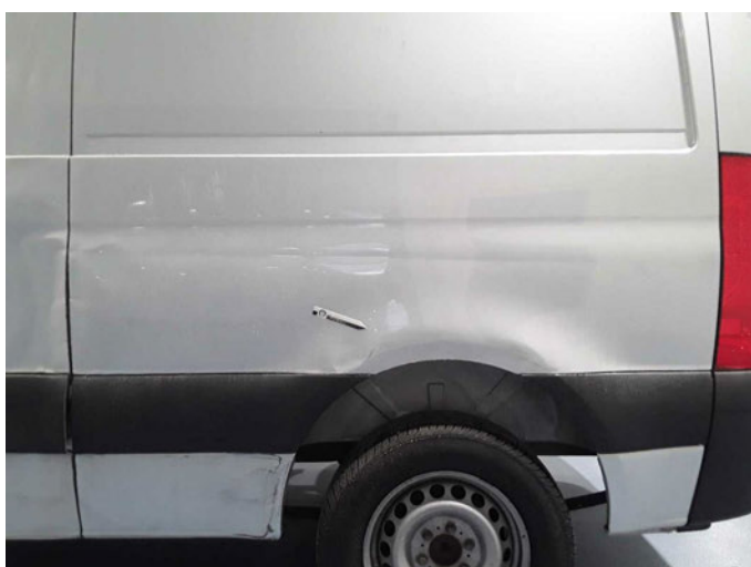
Beschädigung 15: Seitenwand links: Seitenwand - verformt - erneuern
