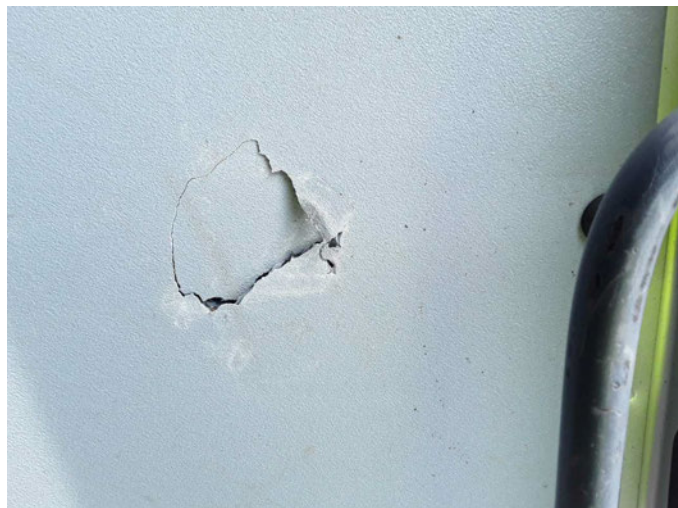
Beschädigung 3: Verkleidungen/Abdeckungen: Laderaumverkleidung rechts - beschädigt - erneuern
