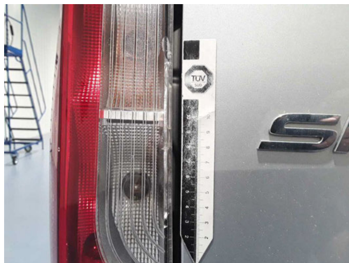
Beschädigung 21: Heckleuchte: Heckleuchte links - beschädigt - erneuern
