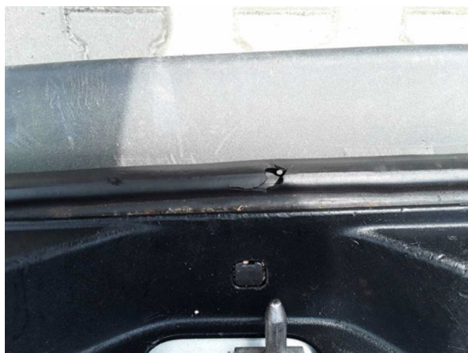
Beschädigung 2: Heckklappe/-tür: Dichtung - beschädigt - erneuern
