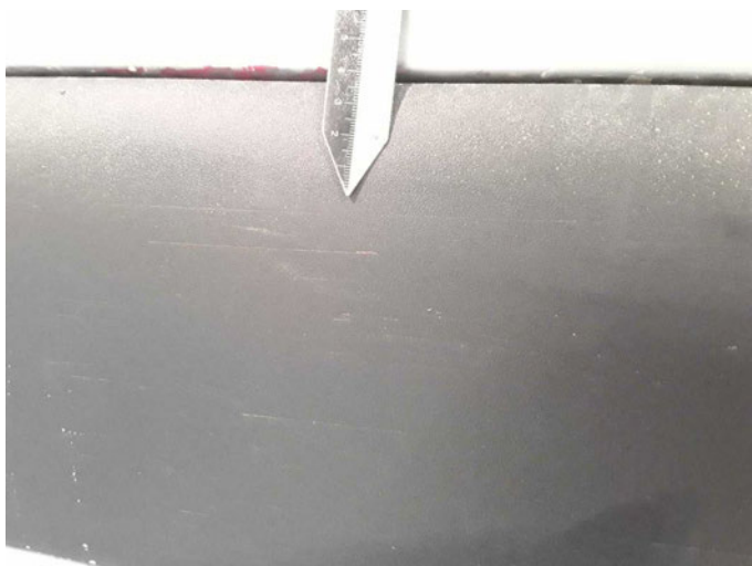
Beschädigung 30: Schiebetür rechts: Schutzleiste - verkratzt / verschürft - erneuern
