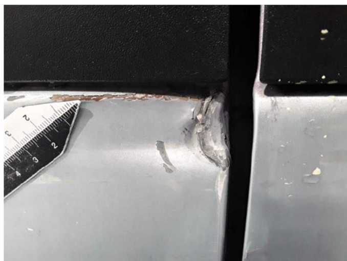
Beschädigung 29: Schweller rechts: Schweller - beschädigt - erneuern
