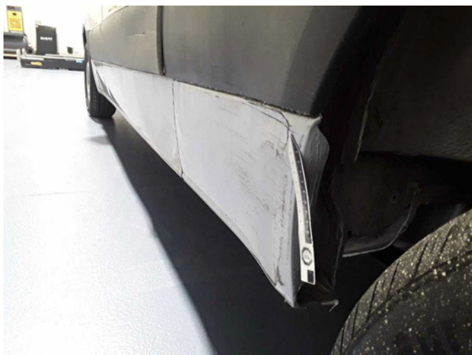
Beschädigung 17: Schweller links: Schweller - verformt - erneuern
