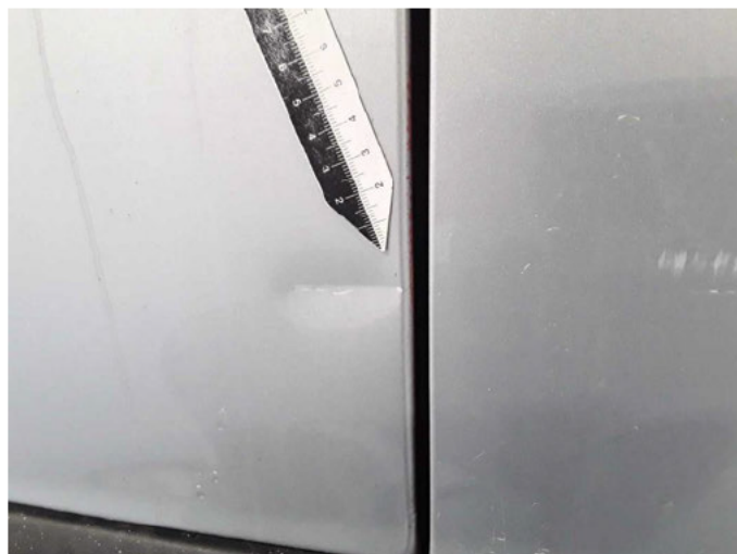
Beschädigung 28: Seitenwand rechts: Seitenwand - gebrochen / gerissen - erneuern
