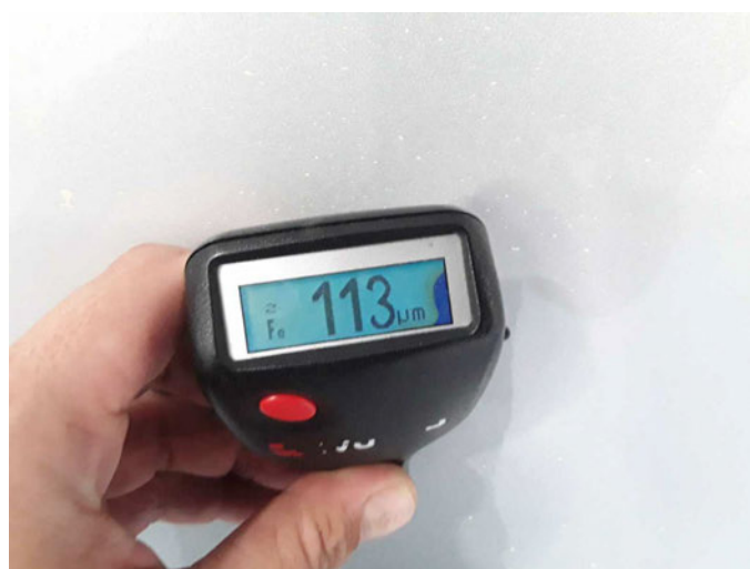
Tür hinten rechts: 113 \mu\text{m}
