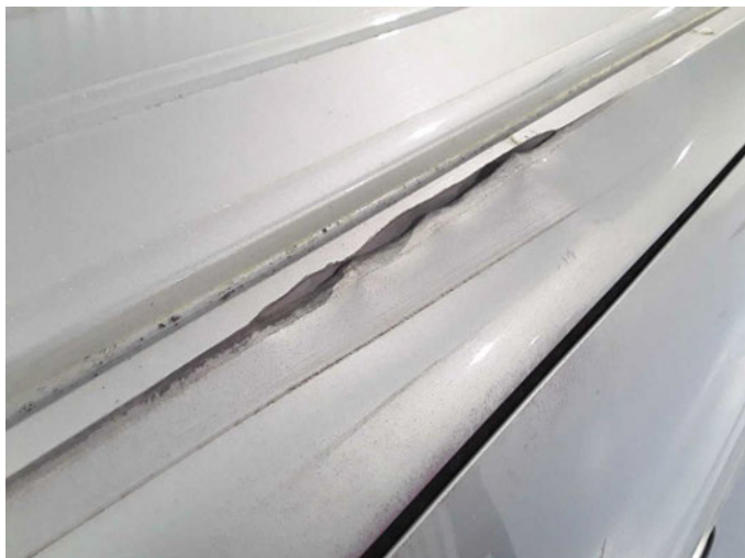
Beschädigung 44: Fahrzeugdach: Dachholm rechts - beschädigt - erneuern
