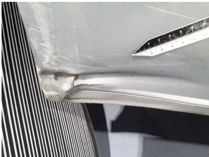
Beschädigung 29: Schweller rechts: Schweller - beschädigt - erneuern
