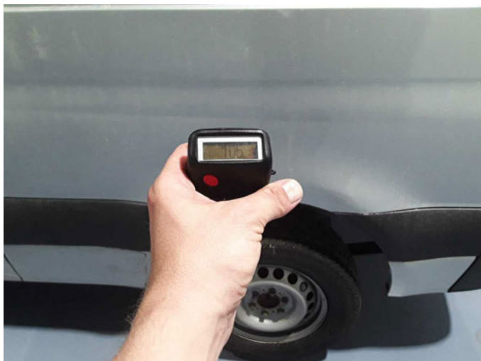
Seitenwand links: 105 \mu\text{m}
