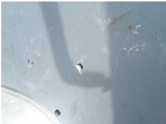
Beschädigung 3: Verkleidungen/Abdeckungen: Laderaumverkleidung rechts - beschädigt - erneuern
