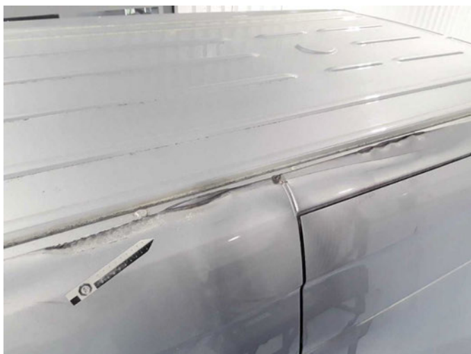
Beschädigung 44: Fahrzeugdach: Dachholm rechts - beschädigt - erneuern
