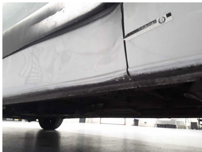
Beschädigung 17: Schweller links: Schweller - verformt - erneuern
