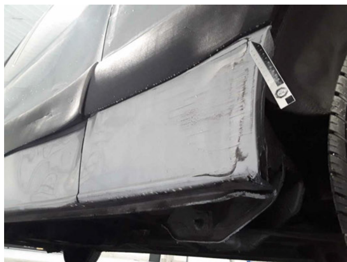
Beschädigung 17: Schweller links: Schweller - verformt - erneuern
