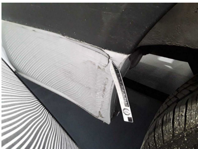
Beschädigung 17: Schweller links: Schweller - verformt - erneuern
