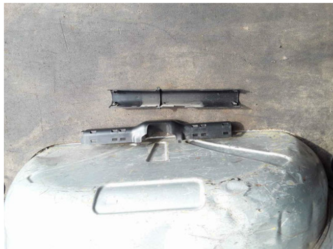
Beschädigung 6: Verkleidungen/Abdeckungen: Dachverkleidung Mitte - beschädigt - erneuern
