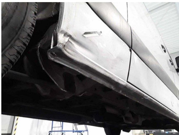
Beschädigung 29: Schweller rechts: Schweller - beschädigt - erneuern
