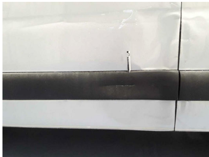
Beschädigung 16: Seitenwand links: Schutzleiste - beschädigt - erneuern
