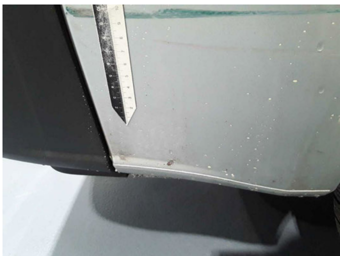
Beschädigung 27: Seitenwand rechts: Radlauf - beschädigt - instandsetzen/lackieren (S3)
