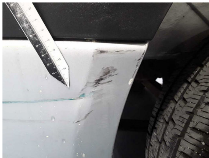
Beschädigung 27: Seitenwand rechts: Radlauf - beschädigt - instandsetzen/lackieren (S3)
