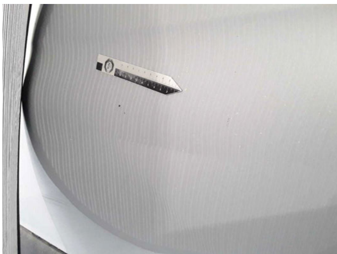
Beschädigung 31: Schiebetür rechts: Schiebetür - verformt - instandsetzen/lackieren (S3)
