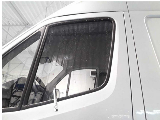
Beschädigung 14: Verglasung: Türscheibe vorn links - Kratzer - erneuern
