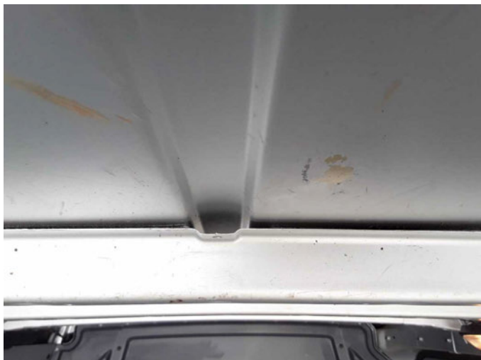
Beschädigung 7: Verkleidungen/Abdeckungen: Dachverkleidung Mitte - entspricht nicht den Herstellervorgaben - instandsetzen und lackieren
