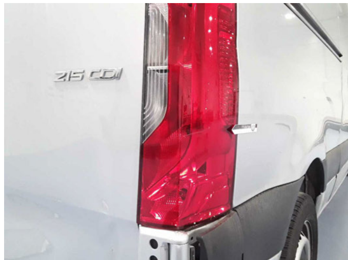
Beschädigung 25: Heckleuchte: Heckleuchte rechts (Sicherheitsrelevante) - Kratzer - erneuern
