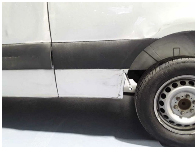
Beschädigung 17: Schweller links: Schweller - verformt - erneuern
