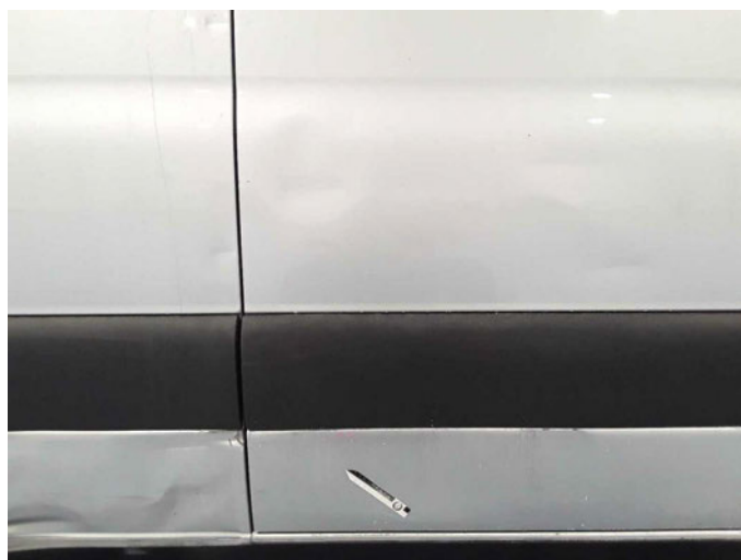
Beschädigung 31: Schiebetür rechts: Schiebetür - verformt - instandsetzen/lackieren (S3)
