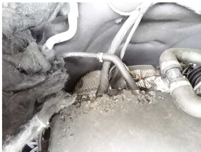
Beschädigung 9: Motor: Motorabdeckung - beschädigt - erneuern
