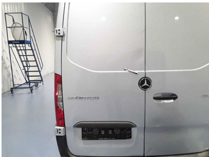
Beschädigung 23: Heckklappe/-tür: Hecktür links - nicht fachgerecht instandgesetzt - erneuern
