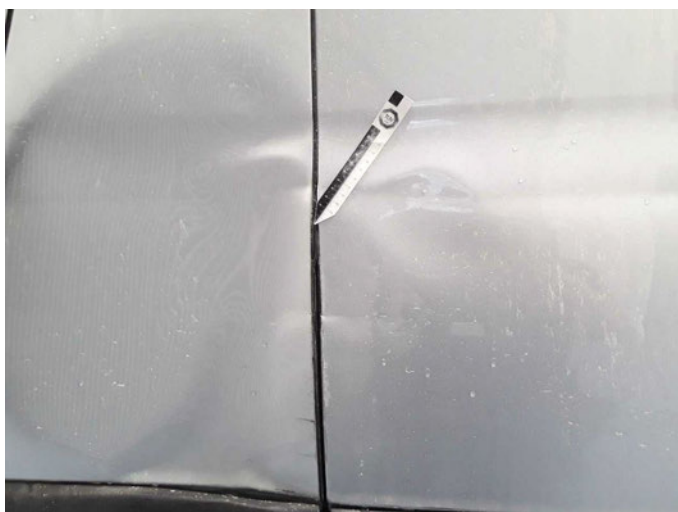
Beschädigung 15: Seitenwand links: Seitenwand - verformt - erneuern
