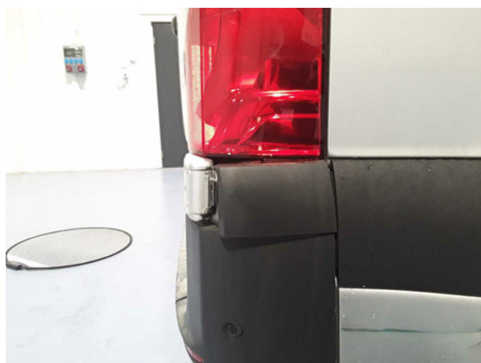
Beschädigung 24: Stossfänger hinten: Schutzleiste rechts - beschädigt - erneuern
