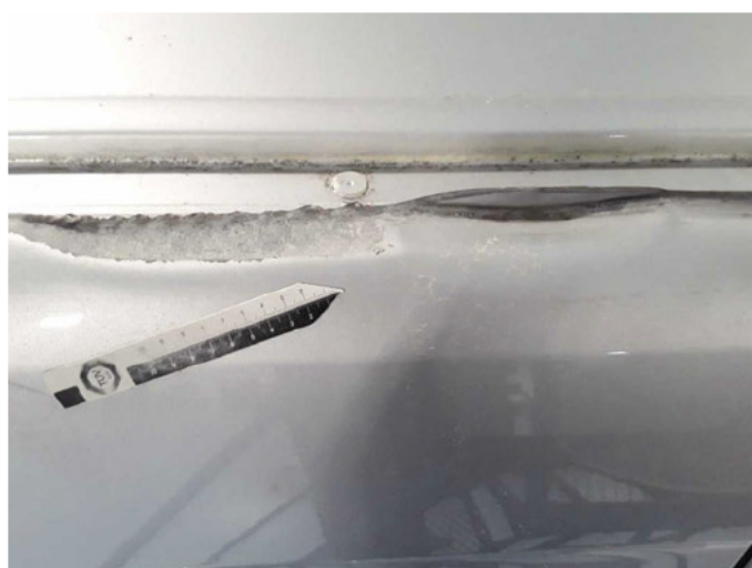
Beschädigung 44: Fahrzeugdach: Dachholm rechts - beschädigt - erneuern
