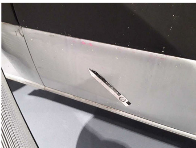
Beschädigung 31: Schiebetür rechts: Schiebetür - verformt - instandsetzen/lackieren (S3)
