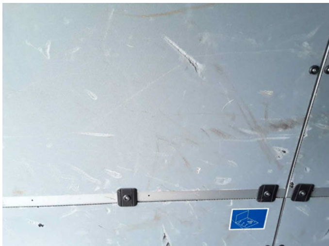
Beschädigung 4: Verkleidungen/Abdeckungen: Laderaumverkleidung links - beschädigt - erneuern
