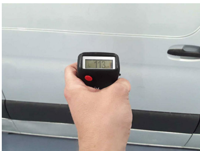
Tür hinten rechts: 113 \mu\text{m}
