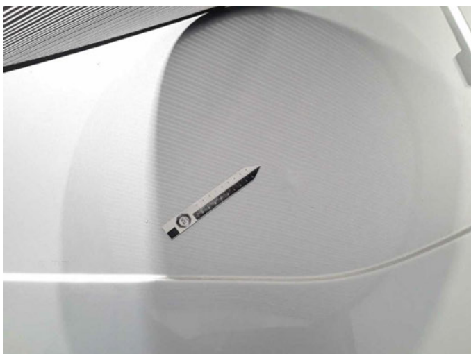
Beschädigung 22: Heckklappe/-tür: Hecktür rechts - verformt - erneuern
