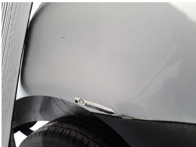
Beschädigung 28: Seitenwand rechts: Seitenwand - gebrochen / gerissen - erneuern
