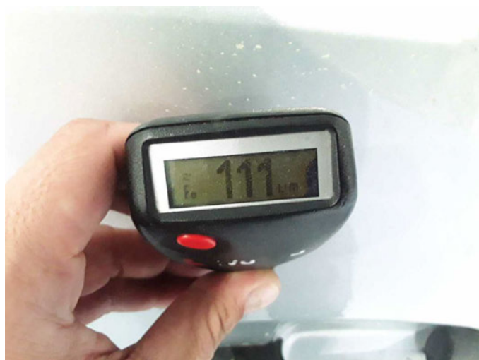
Tür vorne rechts: 111 \mu\text{m}
