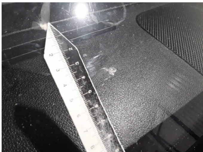
Beschädigung 41: Verglasung: Frontscheibe - gebrochen / gerissen - erneuern
