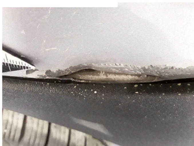
Beschädigung 28: Seitenwand rechts: Seitenwand - gebrochen / gerissen - erneuern
