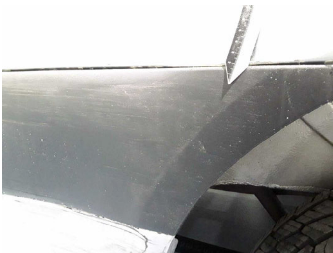
Beschädigung 18: Seitenwand links: Schutzleiste - verkratzt / verschürft - erneuern
