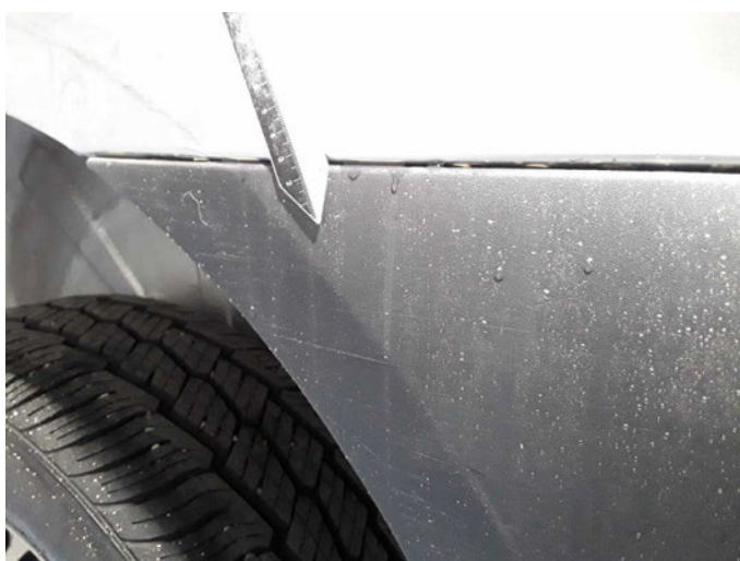
Beschädigung 19: Seitenwand links: Schutzleiste - verkratzt / verschürft - erneuern
