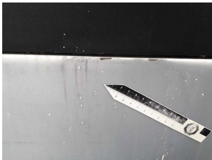
Beschädigung 31: Schiebetür rechts: Schiebetür - verformt - instandsetzen/lackieren (S3)
