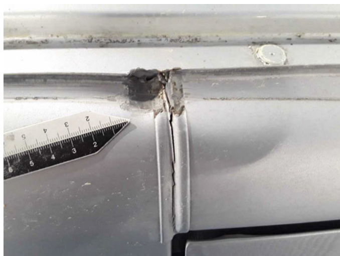
Beschädigung 44: Fahrzeugdach: Dachholm rechts - beschädigt - erneuern
