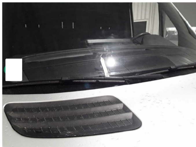
Beschädigung 41: Verglasung: Frontscheibe - gebrochen / gerissen - erneuern
