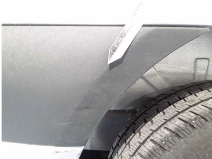
Beschädigung 26: Seitenwand rechts: Schutzleiste - verkratzt / verschürft - erneuern
