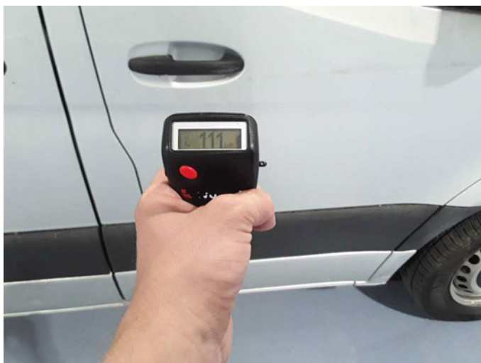
Tür vorne rechts: 111 \mu\text{m}
