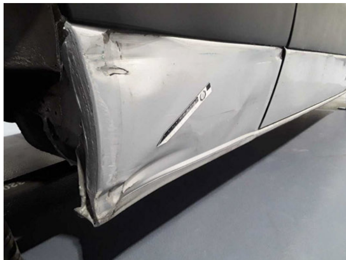
Beschädigung 29: Schweller rechts: Schweller - beschädigt - erneuern
