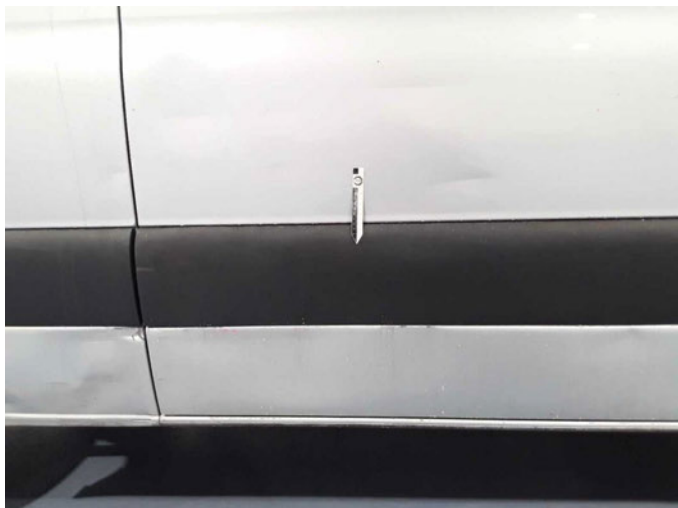
Beschädigung 30: Schiebetür rechts: Schutzleiste - verkratzt / verschürft - erneuern
