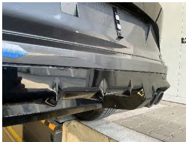
Beschädigung #5: Stossfänger hinten: Spoiler (Ober und unterteil) - verformt - erneuern
