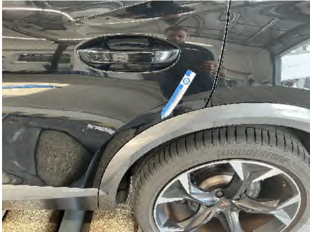
Beschädigung #1: Kotflügel links: Radhausverbreiterung - verkratzt / verschürft - Smart Repair
