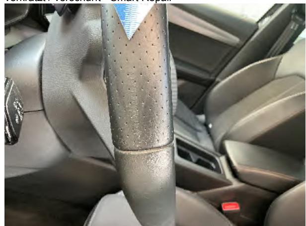
Beschädigung #2: Lenkanlage: Lenkrad - verkratzt / verschürft - Smart Repair
