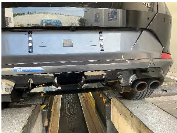
Beschädigung #5: Stossfänger hinten: Spoiler (Ober und unterteil) - verformt - erneuern
