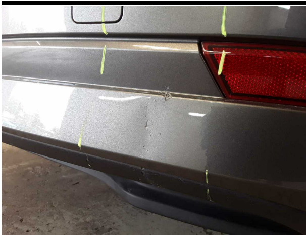
Beschädigung #6: Stossfänger hinten: Stossfänger hinten - verkratzt / verschürft - instandsetzen und lackieren
