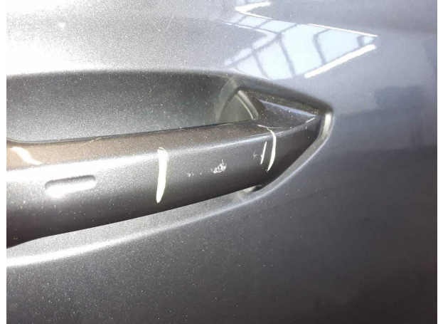
Beschädigung #3: Tür vorn rechts: Griff außen - verkratzt / verschürft - Smart Repair
