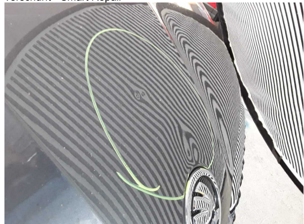
Beschädigung #4: Motorhaube: Motorhaube - Delle(n) - sanft instandsetzen
