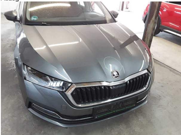
Beschädigung #4: Motorhaube: Motorhaube - Delle(n) - sanft instandsetzen
