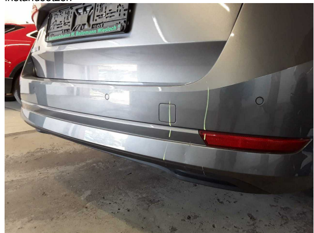
Beschädigung #6: Stoßfänger hinten: Stoßfänger hinten - verkratzt / verschürft - instandsetzen und lackieren
