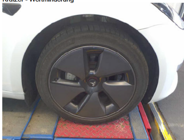
Beschädigung #3: Rad/Reifen: Leichtmetallfelge vorn rechts - Kratzer - Wertminderung
