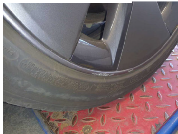
Beschädigung #3: Rad/Reifen: Leichtmetallfelge vorn rechts - Kratzer - Wertminderung
