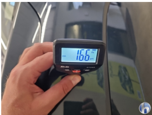
1. Kotflügel Vorne - Links Nachlackiert - Ohne Reparatur
