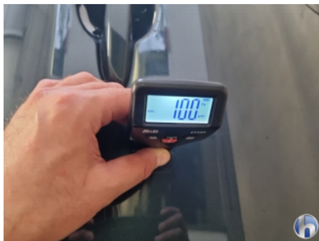
2. Tür Vorne - Links Nachlackiert - Ohne Reparatur
