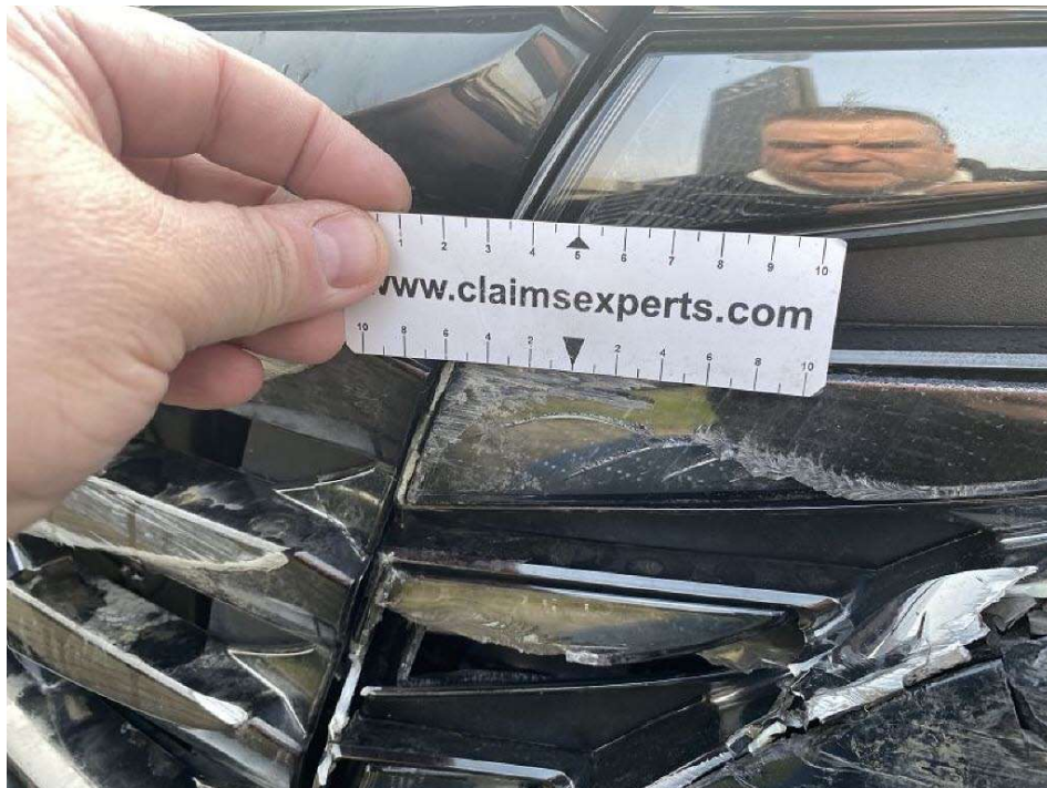
Bild 9 Scheinwerfer vorne links gebrochen und kratzbeschädigt
