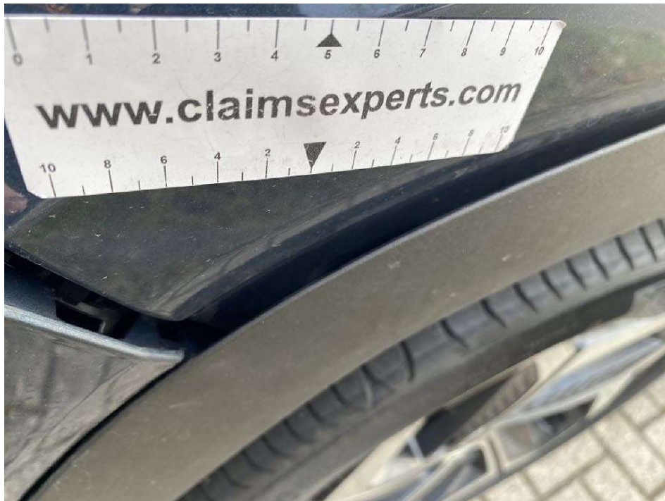
Bild 11 Radlaufleiste vorne links verformt
