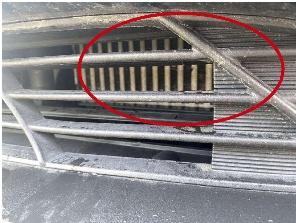
Bild 18 Kühlergitter vorne unten kratzbeschädigt
