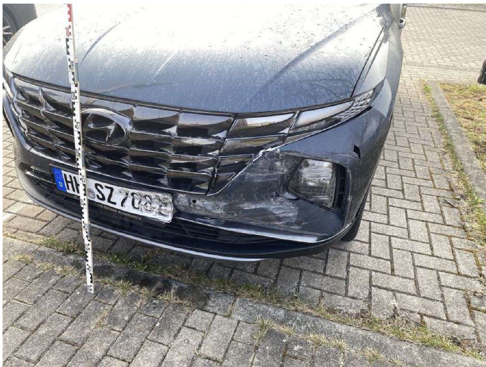
Bild 6 Übersicht Schadenbereich Fahrzeugfront diagonal
