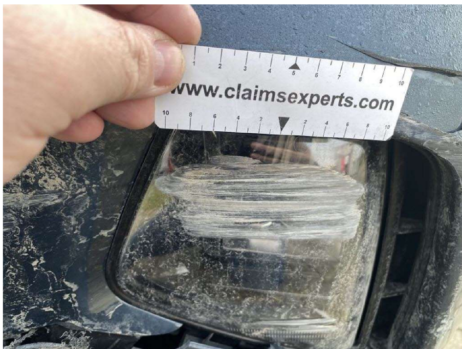
Bild 10 Nebelscheinwerfer vorne links kratzbeschädigt
