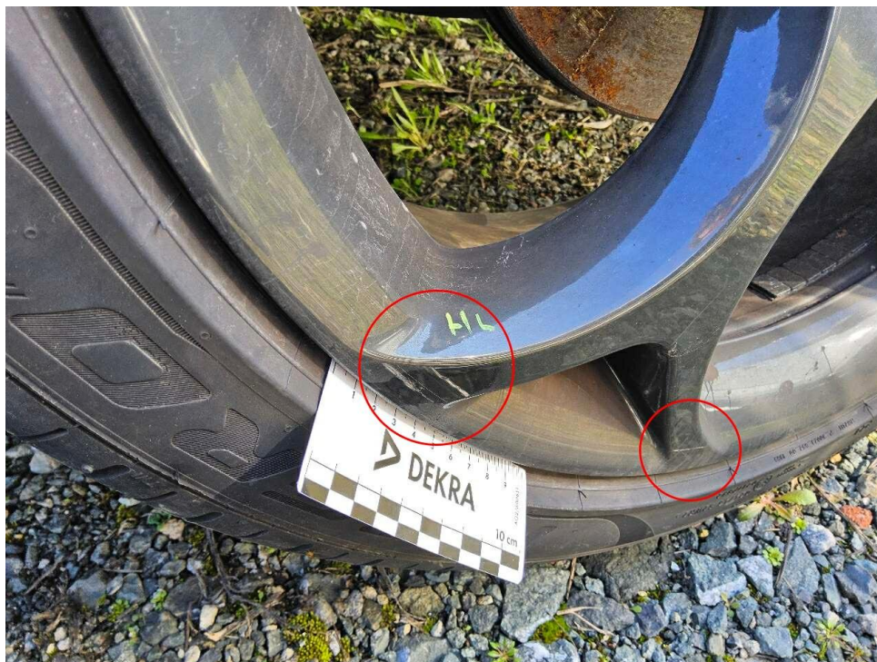
Bild 21 : Felge hinten links Lackierung, zerkratzt, lackieren
