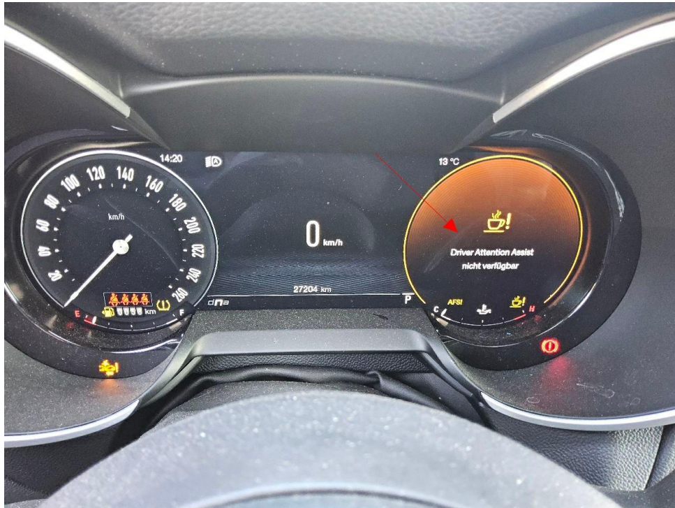
Bild 11 : Elektrik Fehlerspeicher, auslesen Fehler laut Protokoll s. Anhang, prüfen und Befund festlegen, Schadenerweiterung möglich
