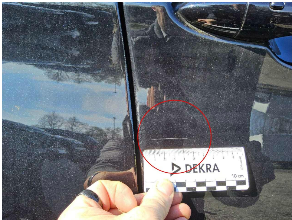
Bild 17 : Tür vorne rechts Lackierung, zerkratzt, smart repair
