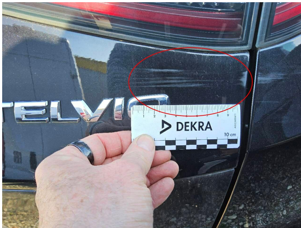
Bild 16 : Heckklappe Lackierung, zerkratzt, polieren
