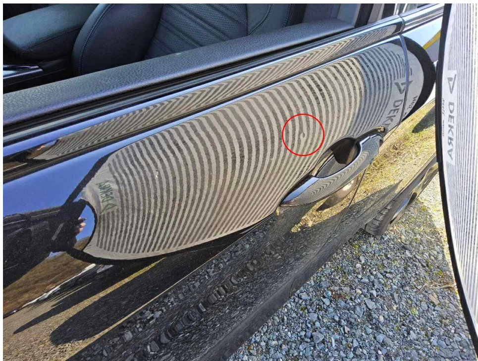
Bild 13 : Tür vorne links, eingedellt, drücken
