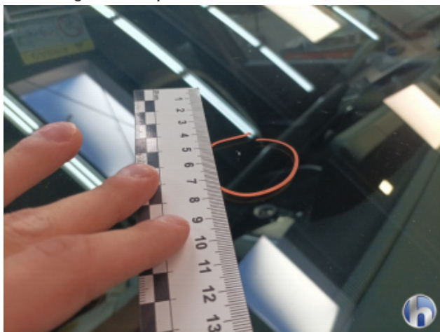
2. Windschutzscheibe Steinschlag - Smart Repair
