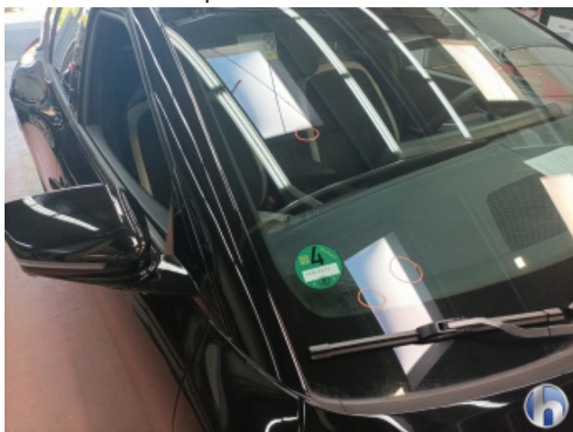
2. Windschutzscheibe Steinschlag - Smart Repair
