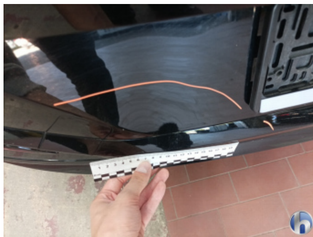
4. Stoßfänger Hinten Kratzer - Lackieren
