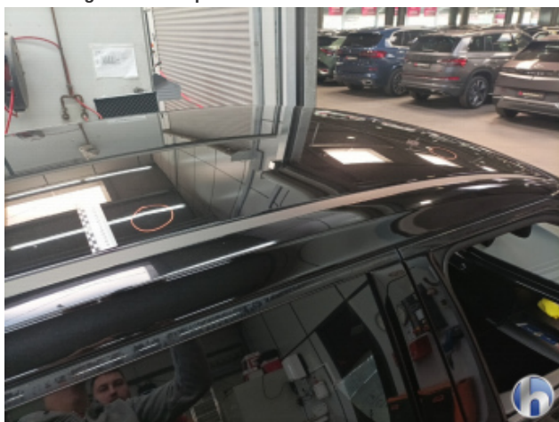
6. Dach Delle - Sanft Instandsetzen
