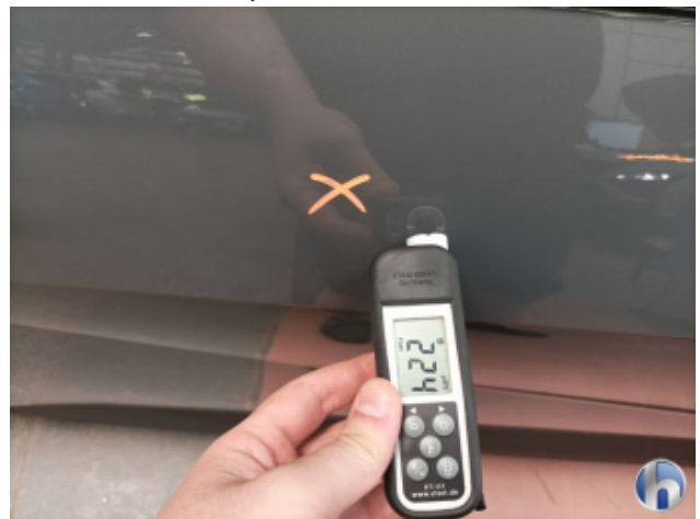
4. Tür Vorne - Links Nachlackiert - Ohne Reparatur
