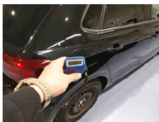
Lackstärke Seitenwand hinten rechts
