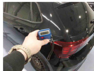
Lackstärke Seitenwand hinten links
