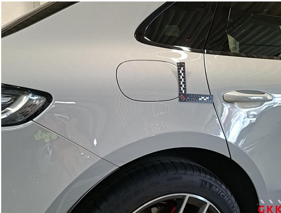
Bild 16 Seitenwand rechts, Reparaturmangel, lackieren
