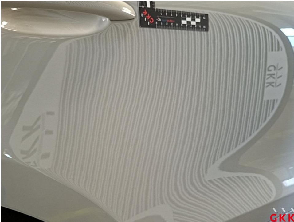
Bild 15 Tür hinten rechts, Reparaturmangel, lackieren
