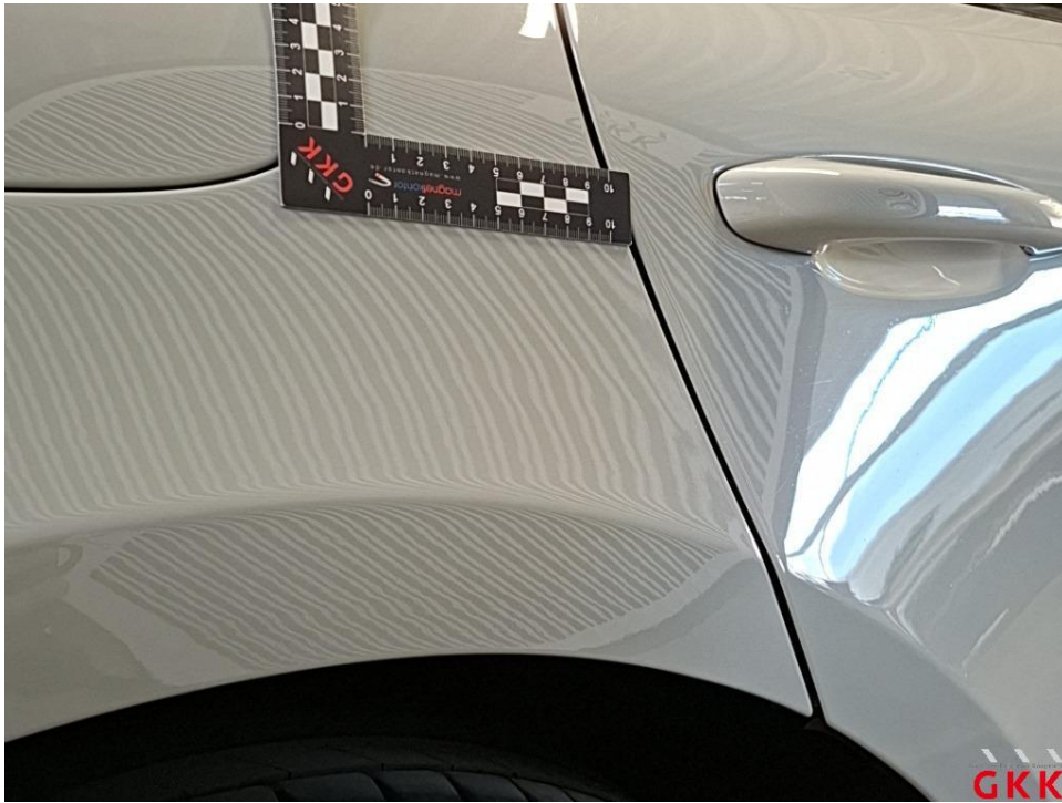
Bild 17 Seitenwand rechts, Reparaturmangel, lackieren
