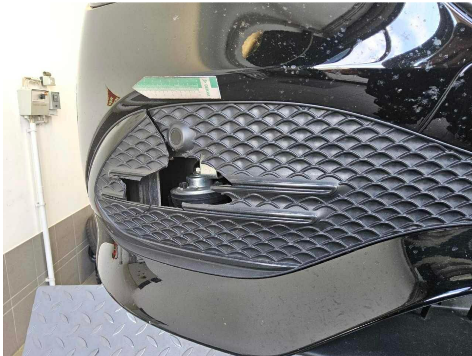
Bild 15 : Kühlergrill, zerbrochen, erneuern
