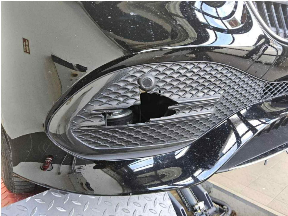
Bild 16 : Kühlergrill, zerbrochen, erneuern
