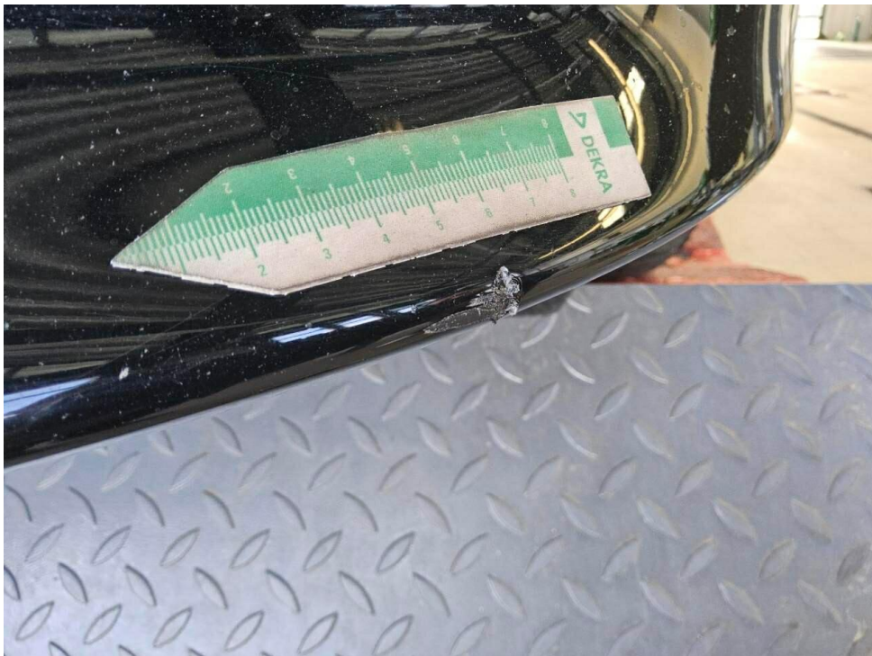
Bild 17 : Stoßfänger vorne, eingedellt, instandsetzen und lackieren mit Lackaufbau
