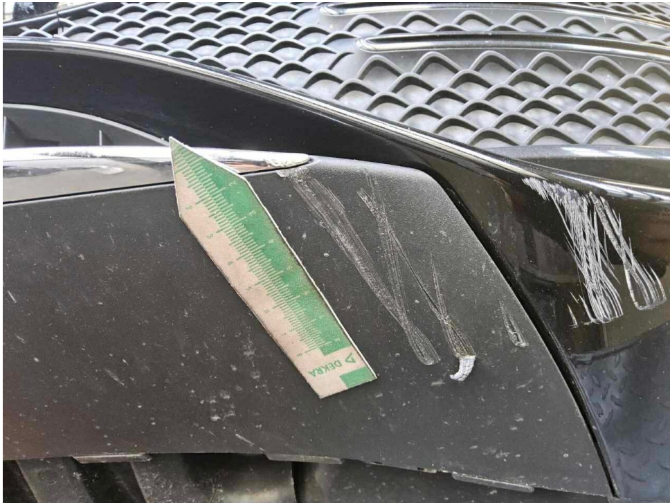
Bild 18 : Frontspoiler, zerkratzt, erneuern
