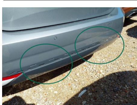
Enjoliveur de moulure de pare-chocs / Arrière / Manquant
