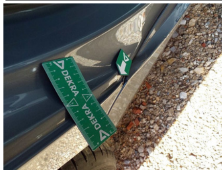
Entrée de porte / Arrière Droit / Enfoncement
