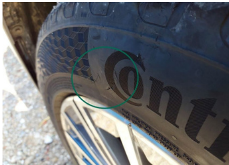
Pneu / Avant Gauche / Déchiré
