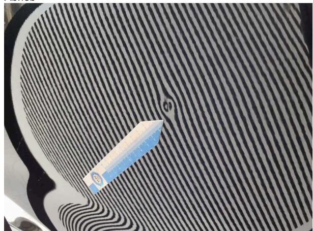
Beschädigung 2: Tür hinten rechts: Tür (Vorschaden) - Delle(n)
