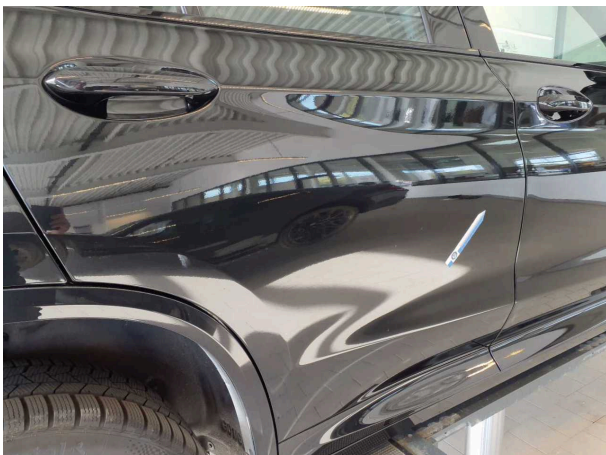
Beschädigung 2: Tür hinten rechts: Tür (Vorschaden) - Delle(n)
