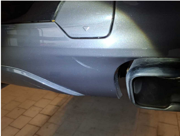
Beschädigung 5: Stossfänger hinten: Spoiler - Kratzer - Smart Repair
