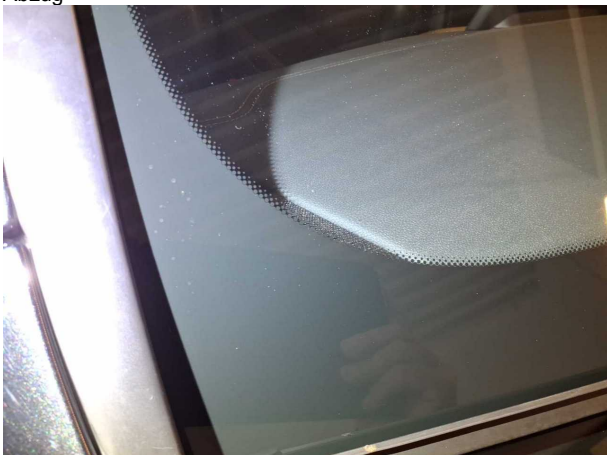
Gebrauchsspur 4: Verglasung: Frontscheibe - Steinschlag - kein Abzug
