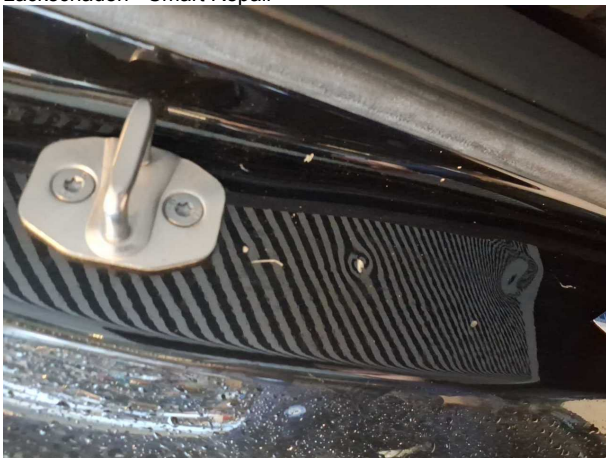
Beschädigung 8: Seitenwand rechts: Einstieg - Delle / Lackschaden - Smart Repair
