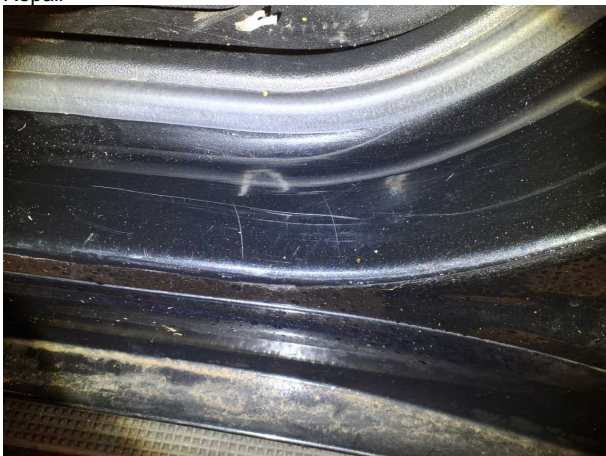
Beschädigung 4: Seitenwand links: Einstieg - Kratzer - Smart Repair
