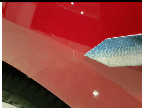
Beschädigung #9: Seitenwand rechts: Seitenwand - Delle / Lackschaden - instandsetzen und lackieren
