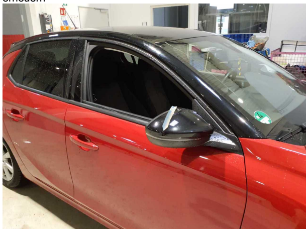
Beschädigung #3: Außenspiegel rechts: Abdeckkappe - verkratzt / verschürft - lackieren
