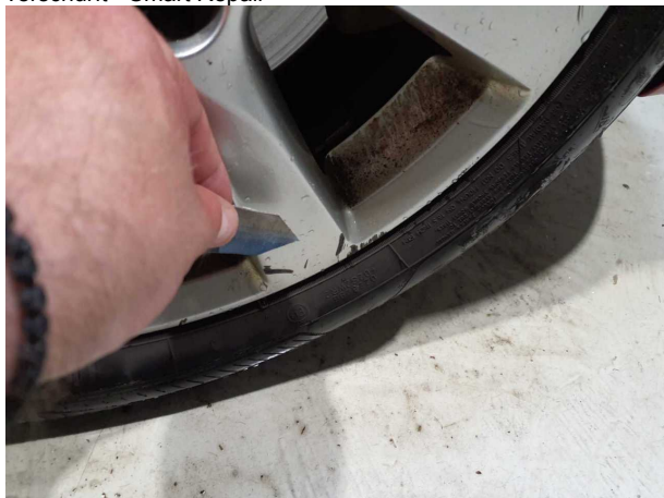
Beschädigung #6: Rad/Reifen: Leichtmetallfelge vorn rechts (Materialabtrag) - Abrieb - erneuern
