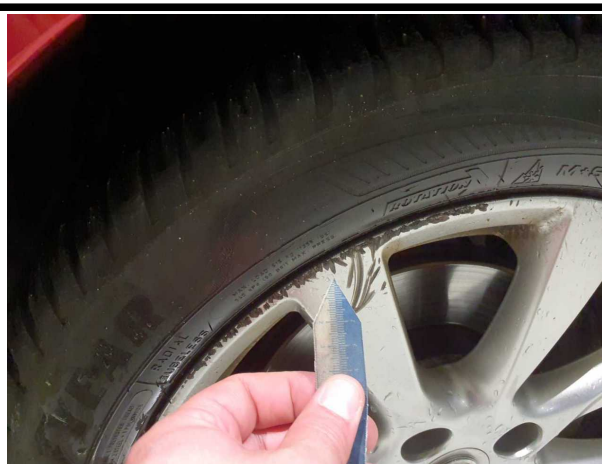
Beschädigung #6: Rad/Reifen: Leichtmetallfelge vorn rechts (Materialabtrag) - Abrieb - erneuern
