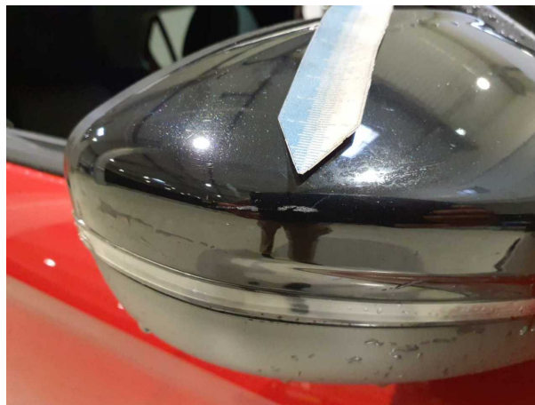
Beschädigung #3: Außenspiegel rechts: Abdeckkappe - verkratzt / verschürft - lackieren
