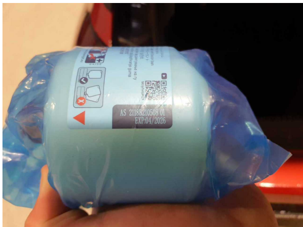
Beschädigung #2: Ausrüstung: Tirefit Füllmittel - abgelaufen - erneuern
