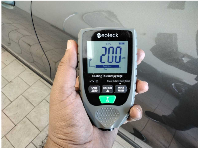
Door - rear left side: 200 µm
