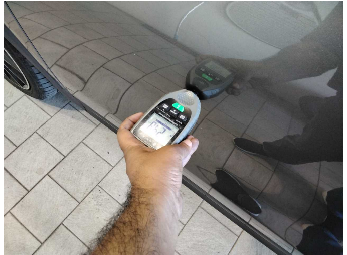
Door - front left side: 248 µm
