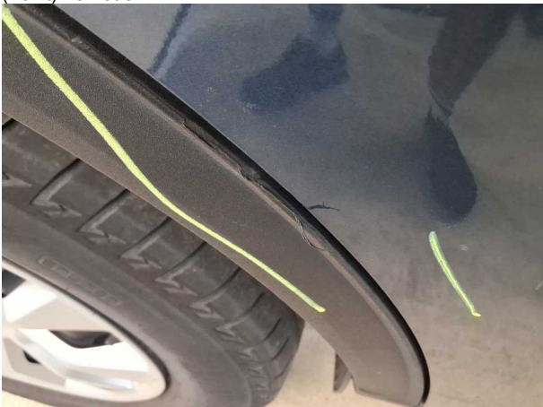
Beschädigung #4: Seitenwand rechts: Radhausverbreiterung - verkratzt / verschürft - erneuern
