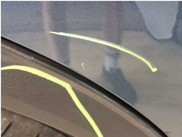
Beschädigung #6: Tür hinten rechts: Tür - verkratzt / verschürft - instandsetzen und lackieren
