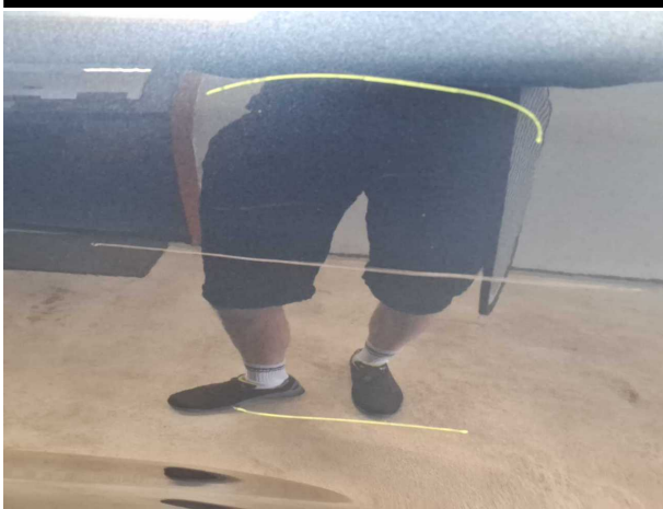
Beschädigung #5: Tür hinten links: Tür - verkratzt / verschürft - instandsetzen und lackieren
