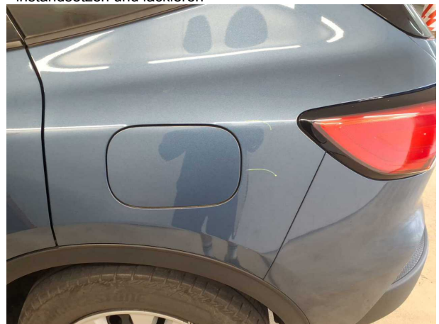
Beschädigung #7: Seitenwand links: Seitenwand - Kratzer - instandsetzen und lackieren
