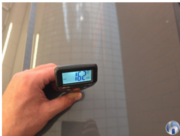
1. Tür Hinten - Links Nachlackiert - Ohne Reparatur
