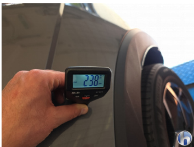
2. Seitenwand - Hinten - Links Nachlackiert - Ohne Reparatur
