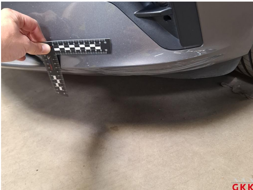
Bild 16 Stoßfänger vorne, Verkleidung -lackiert-, verkratzt, lackieren
