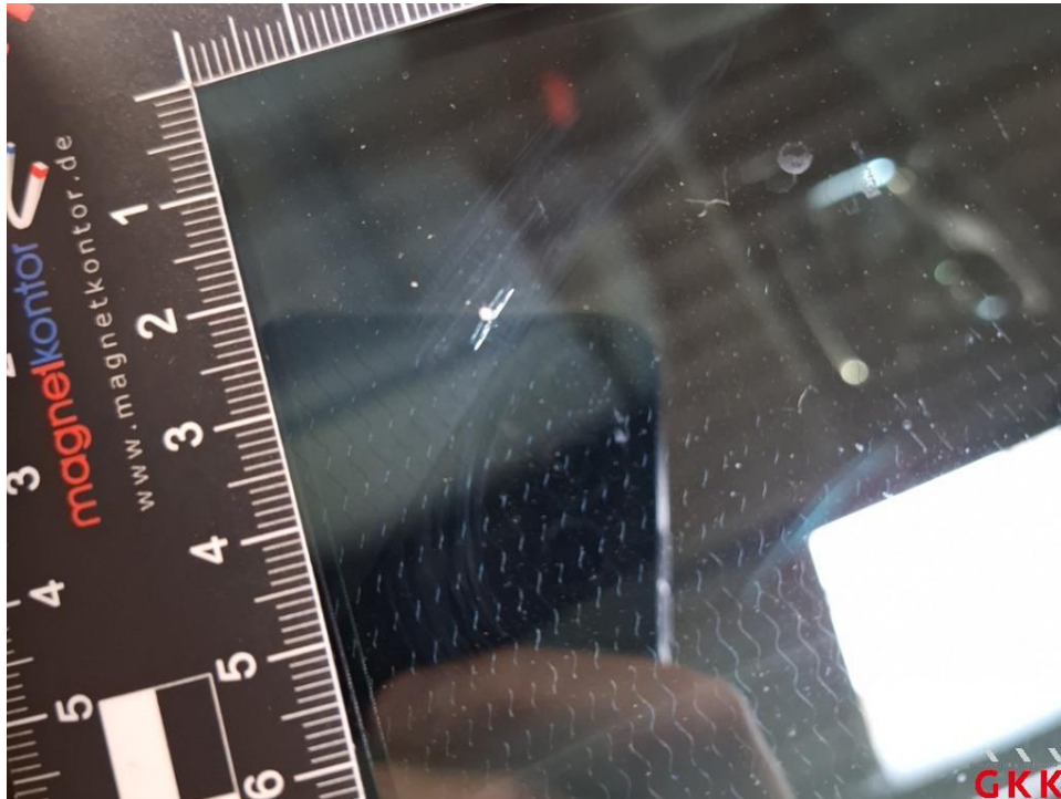
Bild 21 Frontscheibe, mit Regensensor und Frontkamera, Steinschlag mit Rissbildung, instand setzen
