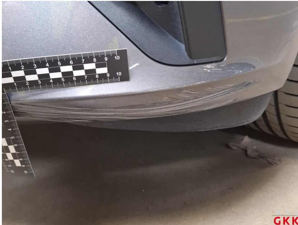
Bild 17 Stoßfänger vorne, Verkleidung -lackiert-, verkratzt, lackieren
