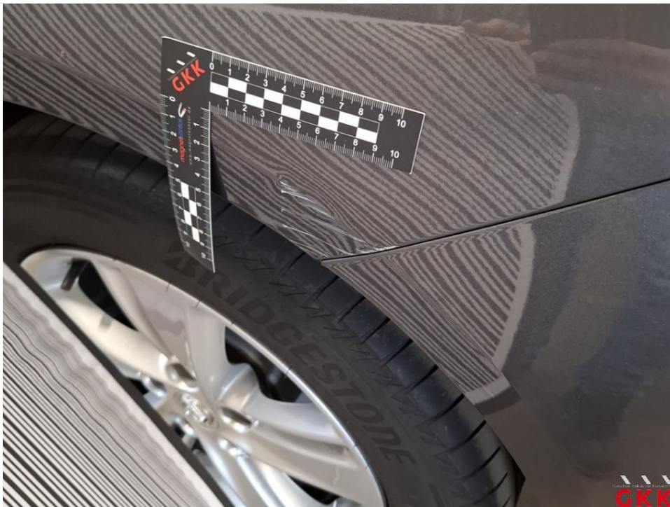
Bild 26 Seitenwand links, beschädigt, instand setzen - lackieren
