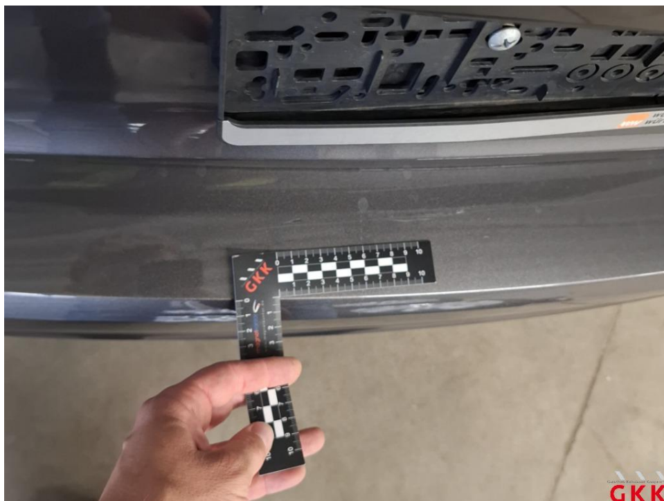
Bild 22 Stoßfänger hinten, Verkleidung -lackiert-, verkratzt, lackieren
