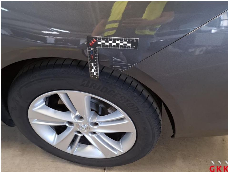
Bild 25 Seitenwand links, beschädigt, instand setzen - lackieren
