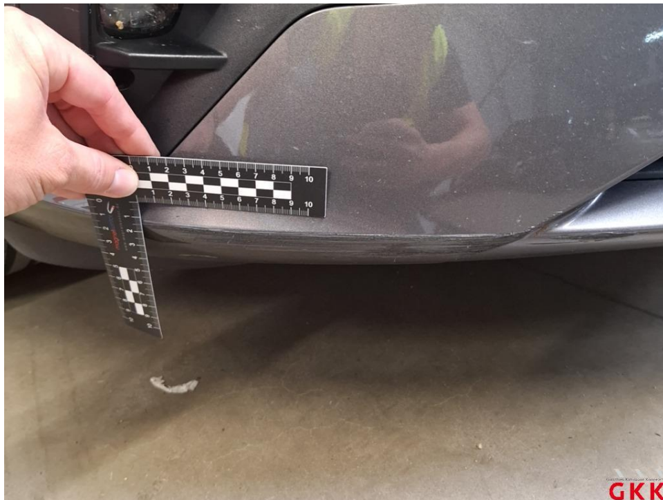
Bild 18 Stoßfänger vorne, Verkleidung -lackiert-, verkratzt, lackieren
