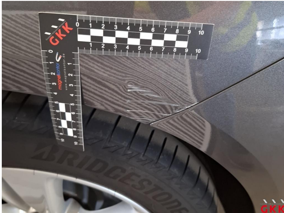
Bild 27 Seitenwand links, beschädigt, instand setzen - lackieren
