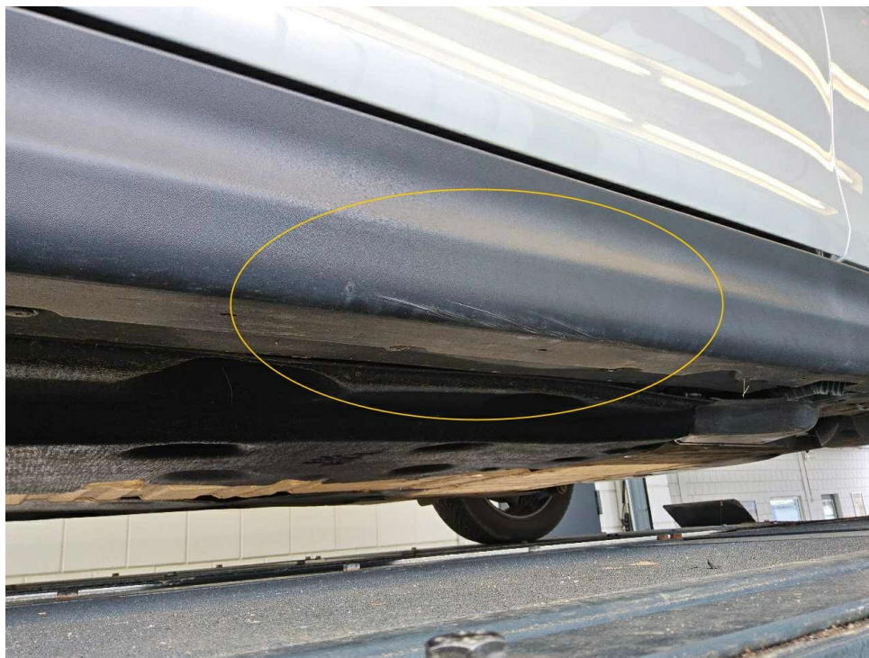
Bild 16 : Schwellerverkleidung links verkratzt
