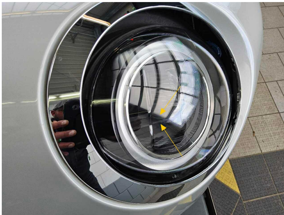
Bild 15 : Hauptscheinwerfer rechts Kratzer
