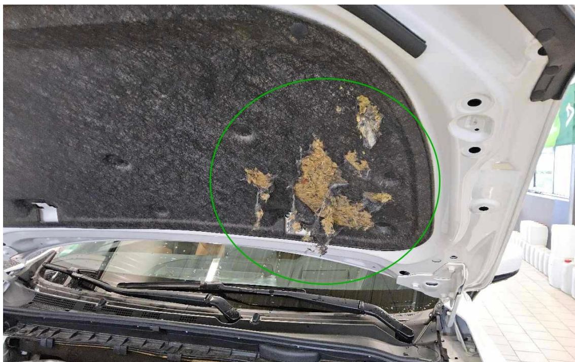
Bild 14 : Dämmung Motorhaube, gerissen
