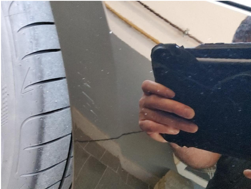
Bild 17 : Stoßfänger hinten Kratzer
