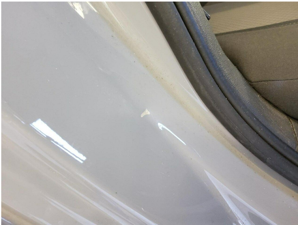
Bild 16 : Tür hinten rechts Einstieg, eingedellt, smart repair
