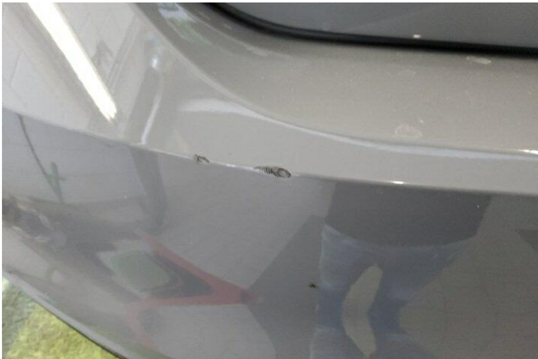
Bild 14 : Stoßfänger hinten Lackierung, verschrammt, lackieren mit Lackaufbau
