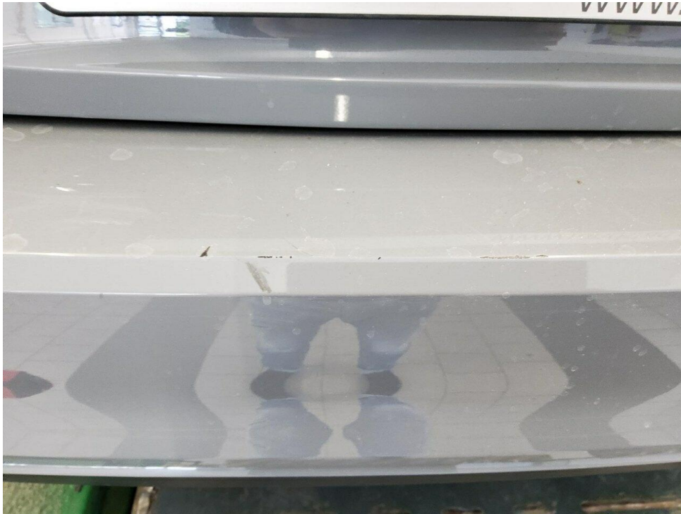
Bild 15 : Stoßfänger hinten Lackierung, verschrammt, lackieren mit Lackaufbau
