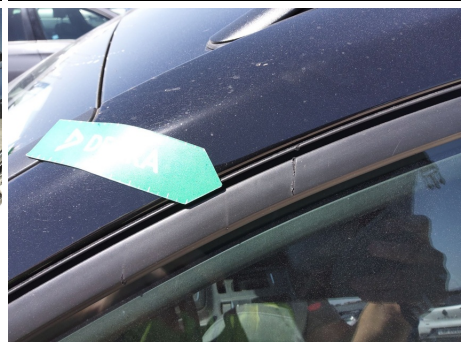
Junta de ventana / Delantero izquierdo / Roto
