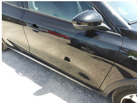
Puerta / Delantero Derecho / Abolladura
