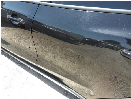
Puerta / Trasero Izquierdo / Abolladura
