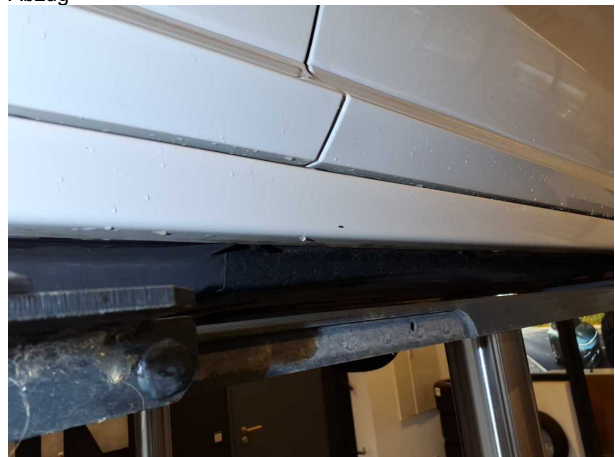
Gebrauchsspur 5: Schweller rechts: Verkleidung - Kratzer - kein Abzug
