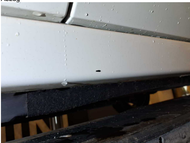
Gebrauchsspur 5: Schweller rechts: Verkleidung - Kratzer - kein Abzug
