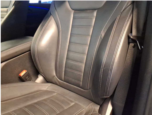
Gebrauchsspur 4: Sitz vorn: Lehnenbezug links - Abrieb - kein Abzug
