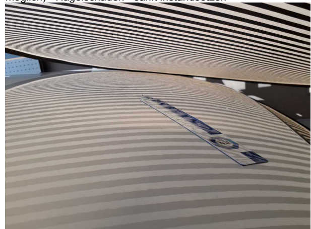
Beschädigung 7: Fahrzeugdach: Dach (ggf Mehrkosten möglich) - Hagelschaden - sanft instandsetzen
