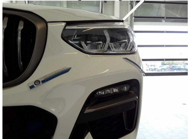
Gebrauchsspur 2: Stossfänger vorn: Stossfänger vorn (Vorschaden) - Steinschlag
