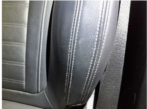
Gebrauchsspur 4: Sitz vorn: Lehnenbezug links - Abrieb - k... Abzug
