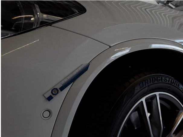
Beschädigung 1: Kotflügel links: Radhausverbreiterung (Vorschaden) - Steinschlag
