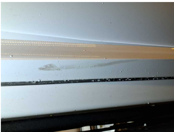
Beschädigung 5: Tür vorn links: Tür - Kratzer - auslegen / polieren
