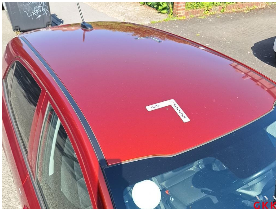
Bild 24 Dach, Lackierung verätzt, aufbereiten
