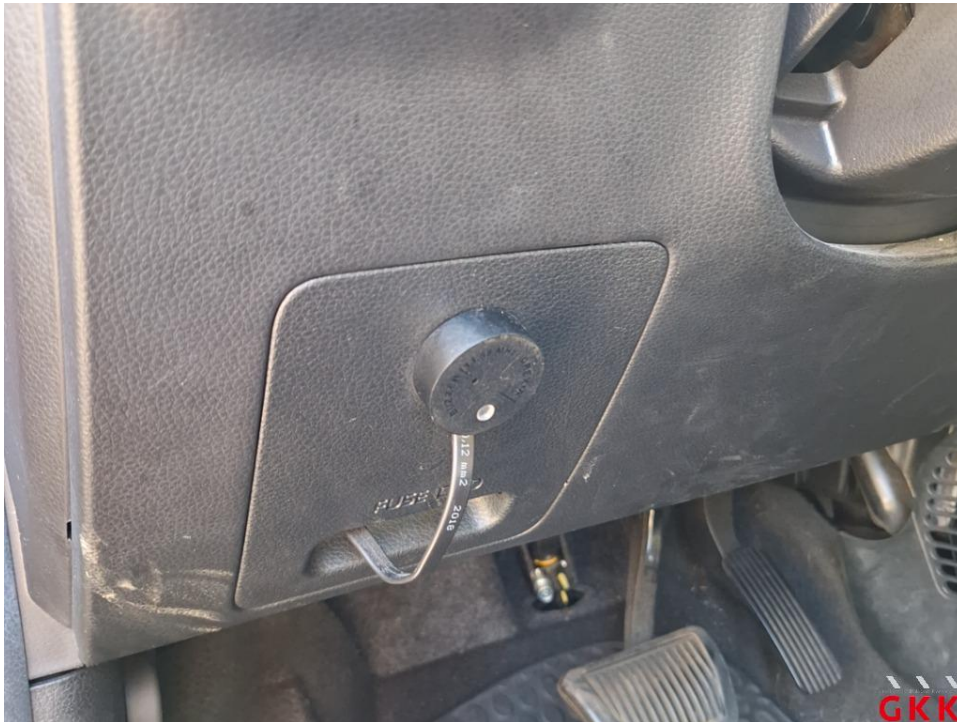
Bild 13 Alarmsicherung / Innenraum, entfernen
