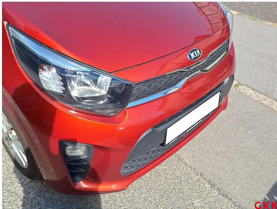
Bild 30 Stoßfänger vorne, Leiste -mittig-, beschädigt, ersetzen
