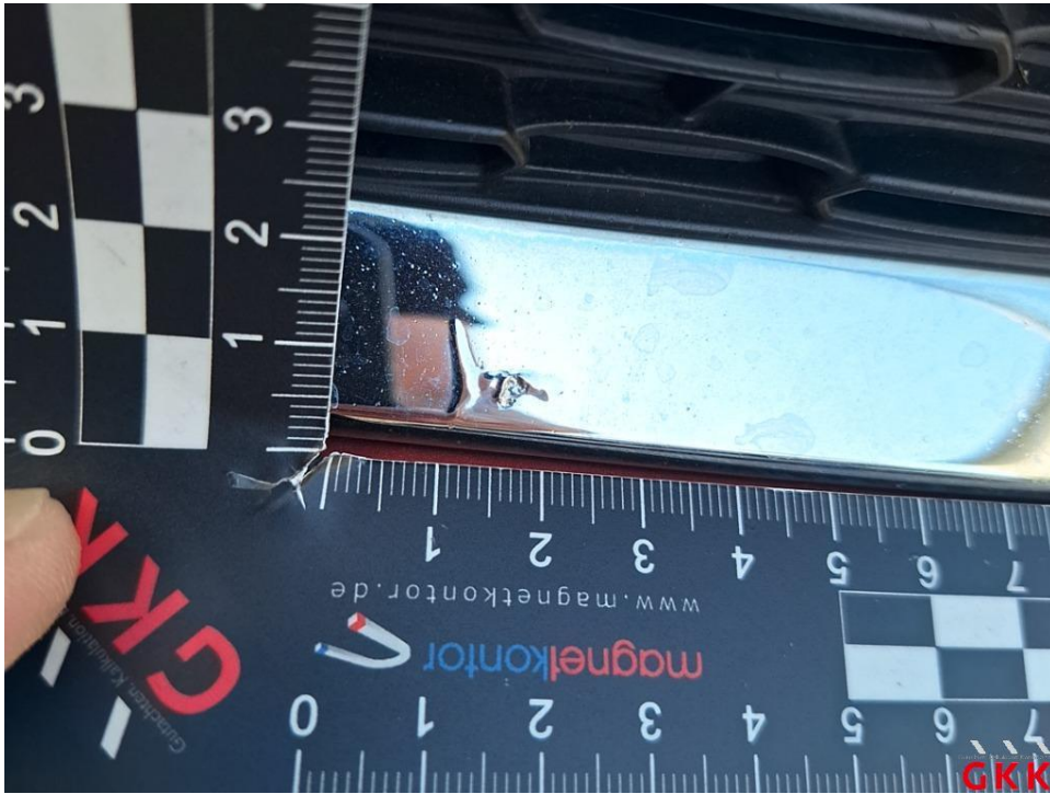
Bild 31 Stoßfänger vorne, Leiste -mittig-, beschädigt, ersetzen
