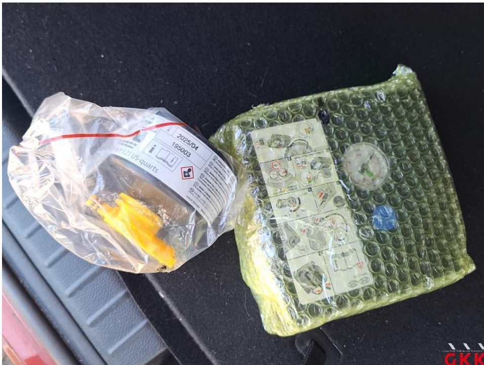
Bild 14 Reifenreparaturset, Füllflasche, MHD überschritten, ersetzen
