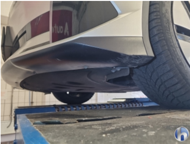
1. Frontspoiler Abschürfung - Smart Repair
