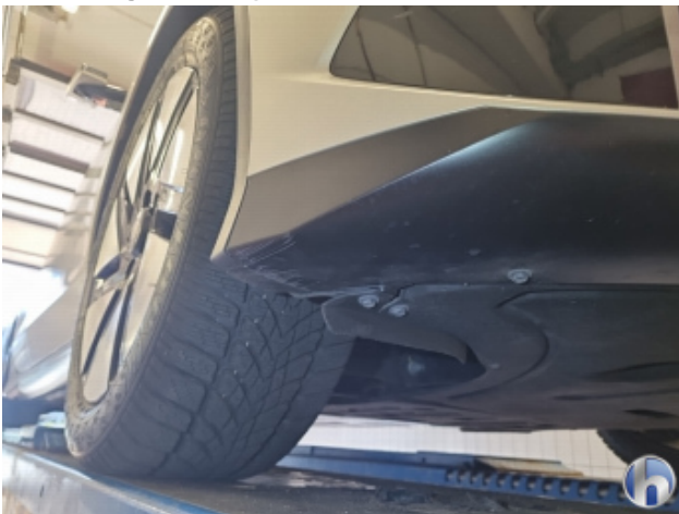
1. Frontspoiler Abschürfung - Smart Repair
