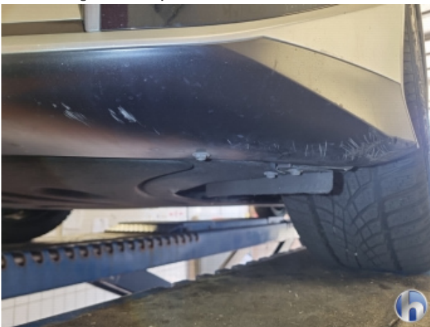
1. Frontspoiler Abschürfung - Smart Repair
