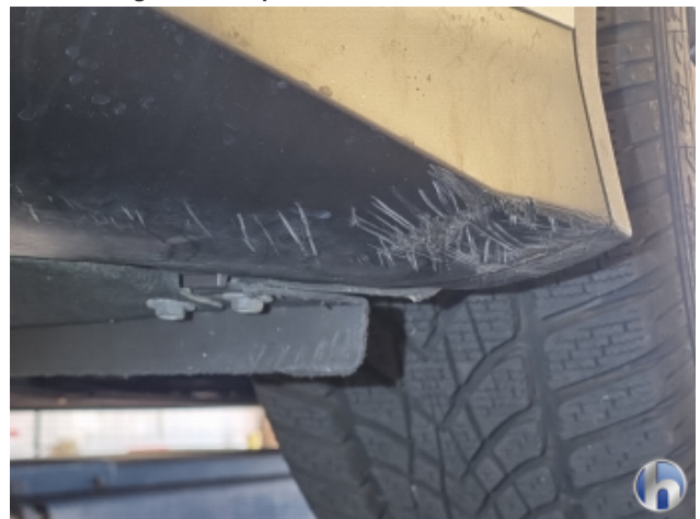
1. Frontspoiler Abschürfung - Smart Repair
