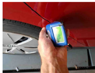
Lackstärke Seitenwand hinten rechts
