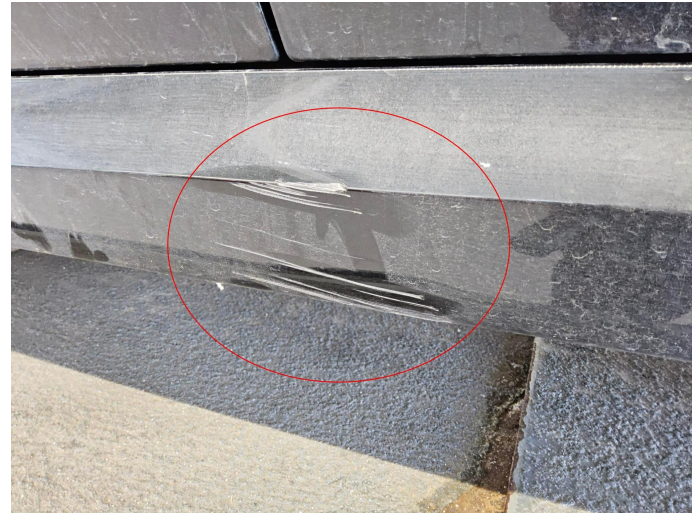
Bild 10: Außen, Seitenschweller links - Lackierung, deformiert , instand- setzen und lackieren mit Lackaufbau
