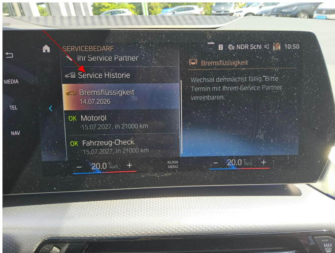
Bild 1: Technik, Wartung , bald fällig , durchführen
