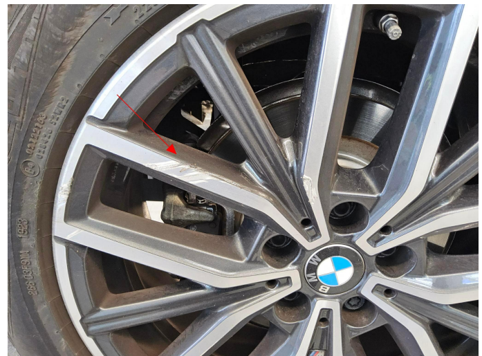
Bild 8: Außen, Felge hinten rechts, Materialabtrag, erneuern
