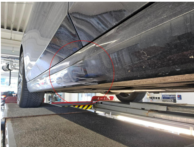
Bild 11: Außen, Seitenschweller links - Lackierung, deformiert , instand- setzen und lackieren mit Lackaufbau
