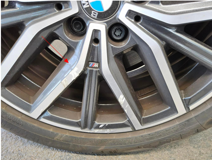
Bild 9: Außen, Felge hinten rechts, Materialabtrag , erneuern
