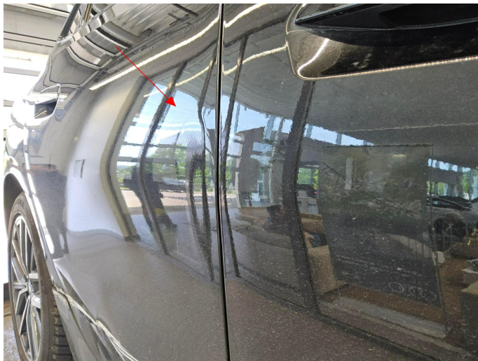
Bild 5: Außen, Tür hinten rechts, deformiert, erneuern und lackieren mit Lackaufbau
