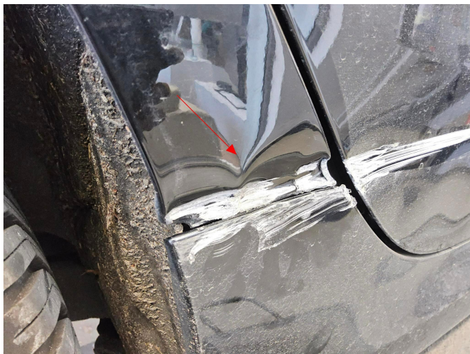
Bild 7: Außen, Seitenteil hinten rechts, deformiert, instandsetzen und lackieren mit Lackaufbau
