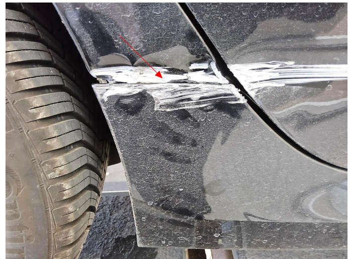
Bild 6: Außen, Seitenschweller rechts, deformiert, erneuern und lackieren mit Lackaufbau
