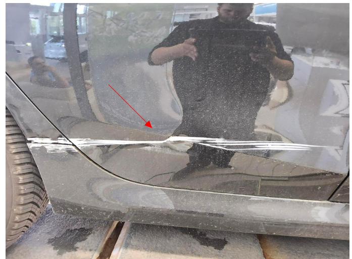
Bild 4: Außen, Tür hinten rechts, deformiert, erneuern und lackieren mit Lackaufbau
