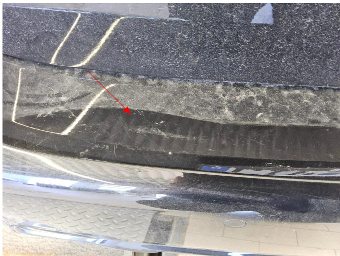
Bild 3: Außen, Stoßfänger hinten, zerkratzt, polieren
