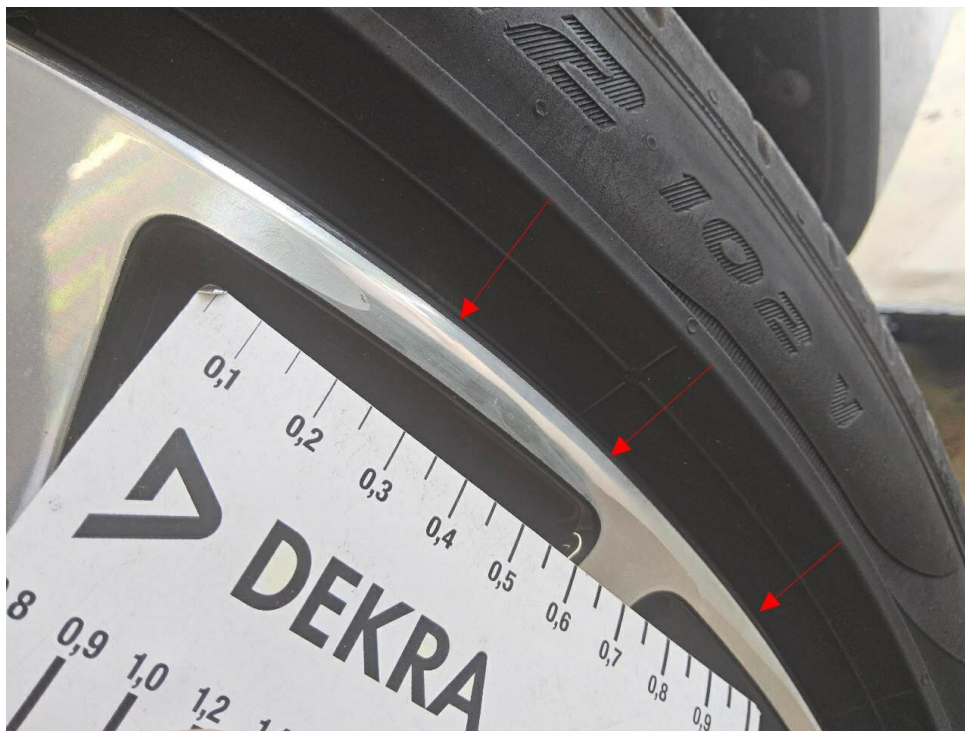
Bild 22 : LM Felge hinten links glanzgedreht verschrammt und verschliffen
