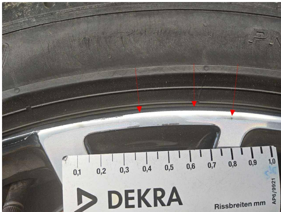
Bild 25 : LM Felge vorne rechts glanzgedreht verschrammt und verschliffen
