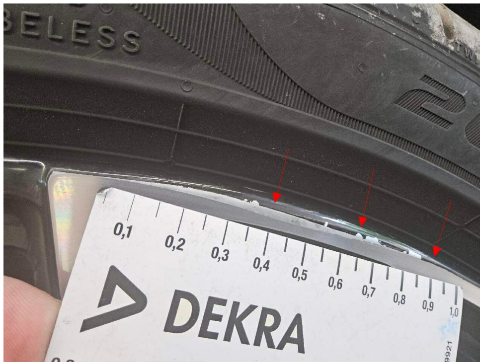
Bild 19 : LM Felge vorne links glanzgedreht verschrammt und verschliffen
