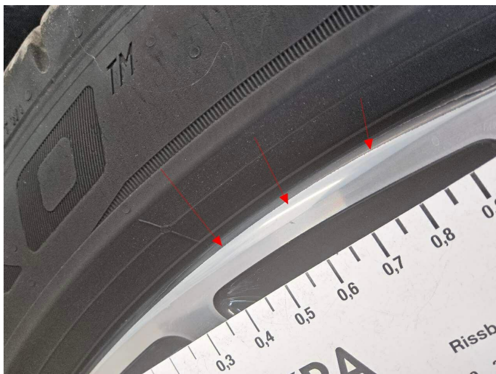
Bild 20 : LM Felge hinten links glanzgedreht verschrammt und verschliffen
