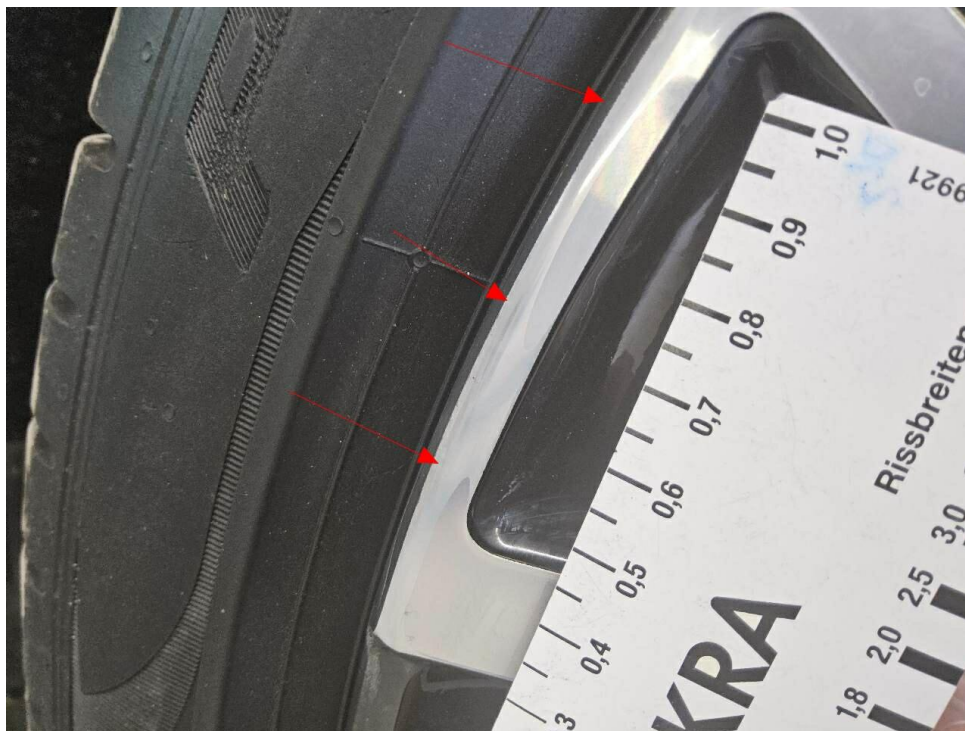
Bild 21 : LM Felge hinten links glanzgedreht verschrammt und verschliffen
