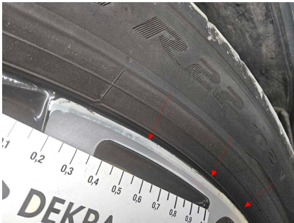
Bild 24 : LM Felge vorne rechts glanzgedreht verschrammt und verschliffen
