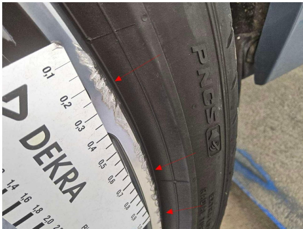
Bild 23 : LM Felge hinten rechts glanzgedreht verschrammt und verschliffen
