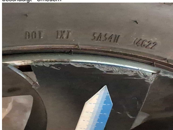
Beschädigung #6: 2.Radsatz: Radblendensatz komplett - beschädigt - erneuern
