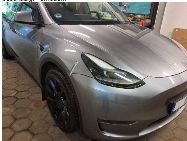
Beschädigung #8: Stossfänger vorn: Stossfänger vorn - verkratzt / verschürft - lackieren
