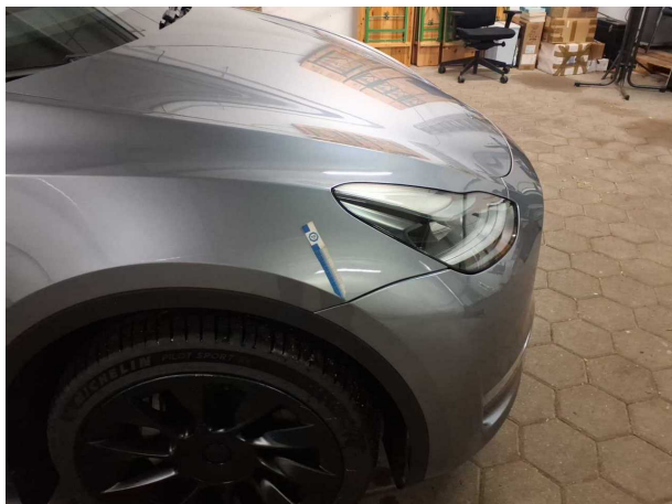
Beschädigung #1: Kotflügel rechts: Kotflügel rechts - verkratzt / verschürft - auslegen / polieren
