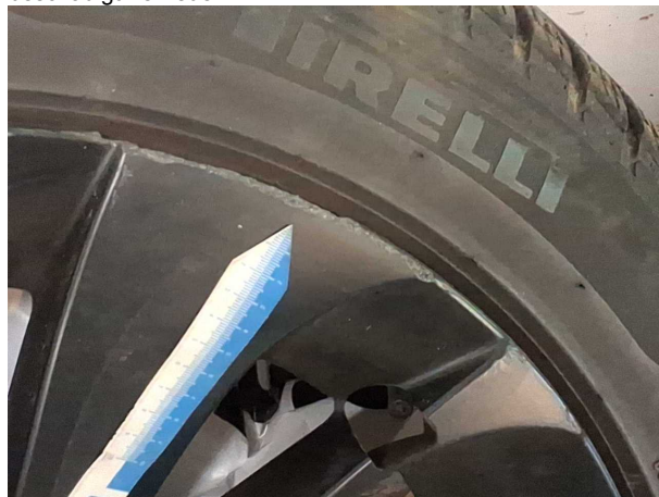
Beschädigung #6: 2.Radsatz: Radblendensatz komplett - beschädigt - erneuern
