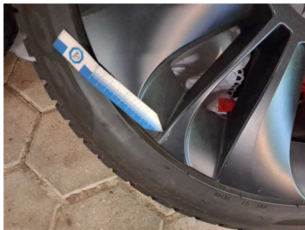
Beschädigung #6: 2.Radsatz: Radblendensatz komplett - beschädigt - erneuern
