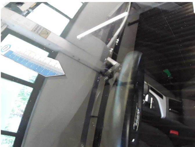
Damage 5: Vehicle glazing: Windscreen (Mit Rissbildung im Fahrersichtfeld, nach Smart Repair) - Unprofessionally repaired - Replace
