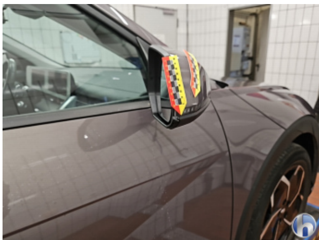
3. Außenspiegel Gehäuse - Rechts Beschädigt - Erneuern
