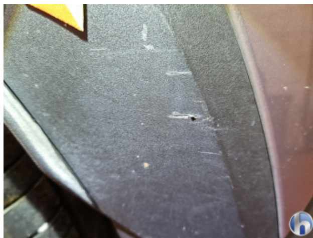
4. Stoßfänger Hinten Kratzer - Instandsetzen und Lackieren
