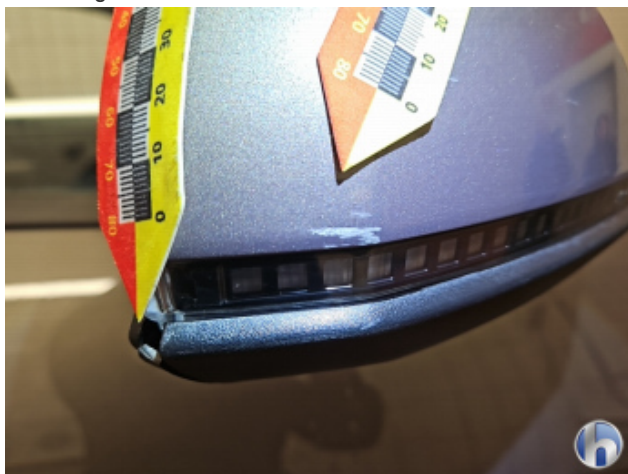
3. Außenspiegel Gehäuse - Rechts Beschädigt - Erneuern
