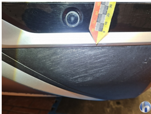
4. Stoßfänger Hinten Kratzer - Instandsetzen und Lackieren
