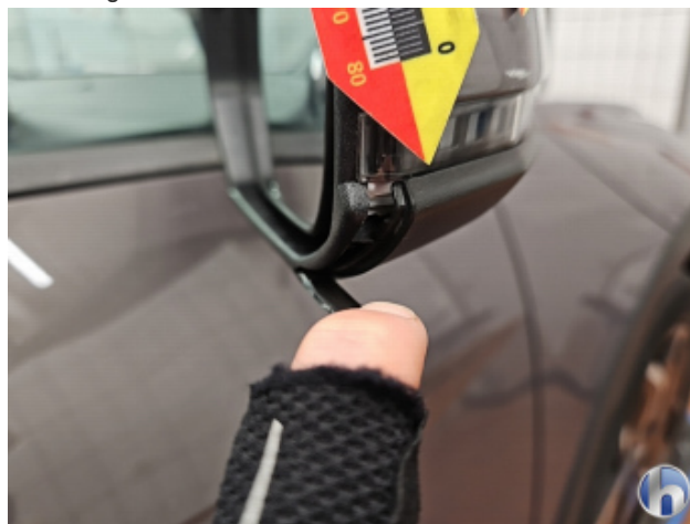
3. Außenspiegel Gehäuse - Rechts Beschädigt - Erneuern
