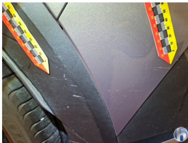
4. Stoßfänger Hinten Kratzer - Instandsetzen und Lackieren
