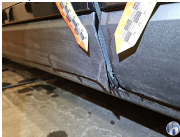
5. Leisten Tür Vorne und Hinten - Links Beschädigt - Erneuern
