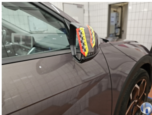
3. Außenspiegel Gehäuse - Rechts Beschädigt - Erneuern
