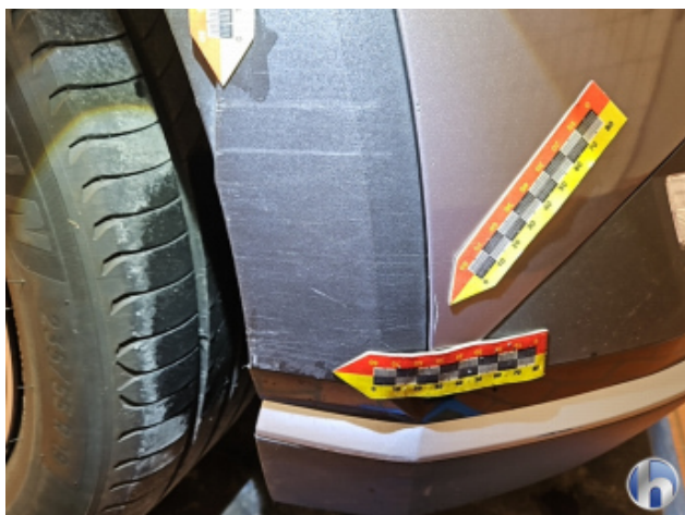
6. Radlaufverbreiterung re.vo. Abschürfung - Erneuern
