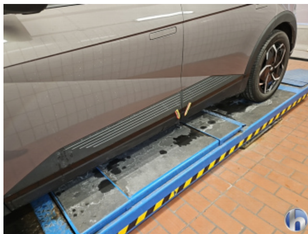
5. Leisten Tür Vorne und Hinten - Links Beschädigt - Erneuern
