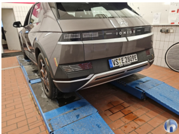
4. Stoßfänger Hinten Kratzer - Instandsetzen und Lackieren
