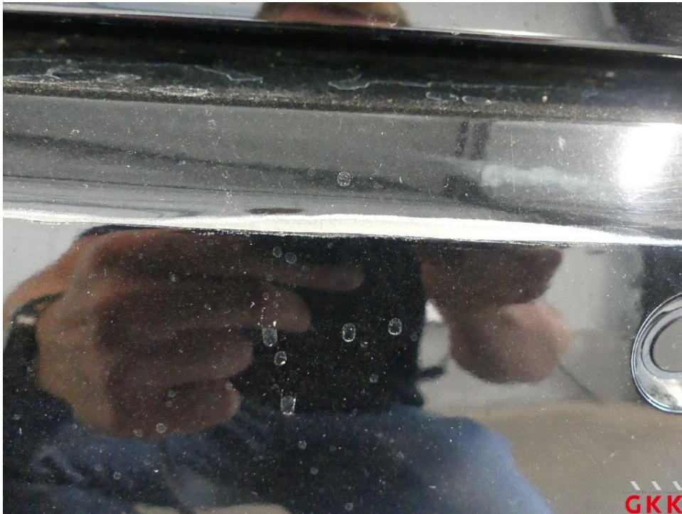
Bild 14. Stoßfänger hinten, Schutzfolie, beschädigt, ersetzen
