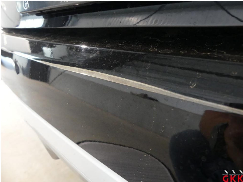
Bild 15. Stoßfänger hinten, Schutzfolie, beschädigt, ersetzen
