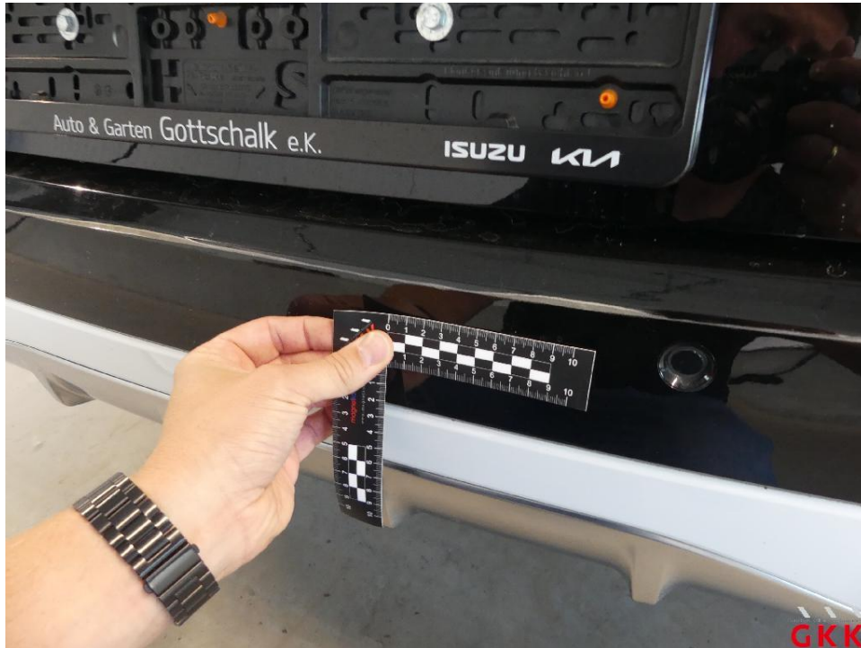
Bild 13. Stoßfänger hinten, Schutzfolie, beschädigt, ersetzen
