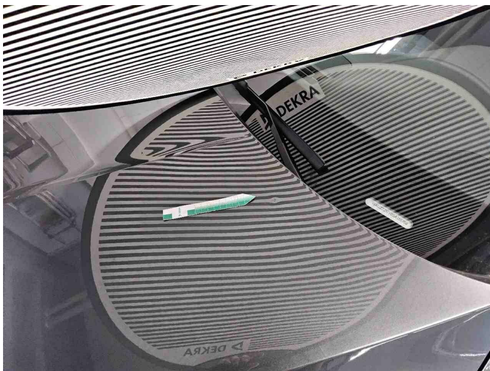
Bild 16 : Motorhaube, eingedellt, Gebrauchsspur
