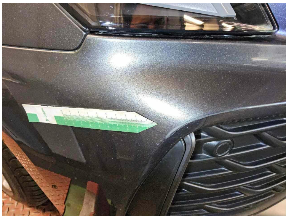
Bild 14 : Stoßfänger vorne Lackierung, zerkratzt, smart repair
