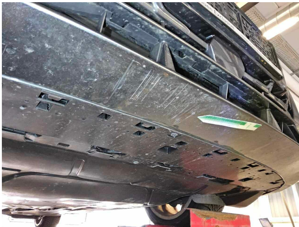
Bild 13 : Stoßfänger vorne Lackierung, zerkratzt, smart repair
