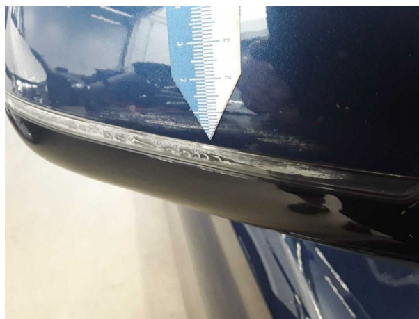
Beschädigung #1: Blinkleuchte: Spiegel rechts - gebrochen / gerissen - erneuern
