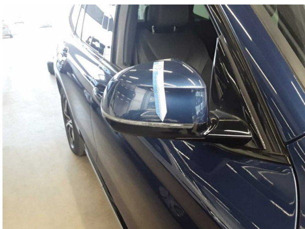
Beschädigung #1: Blinkleuchte: Spiegel rechts - gebrochen / gerissen - erneuern
