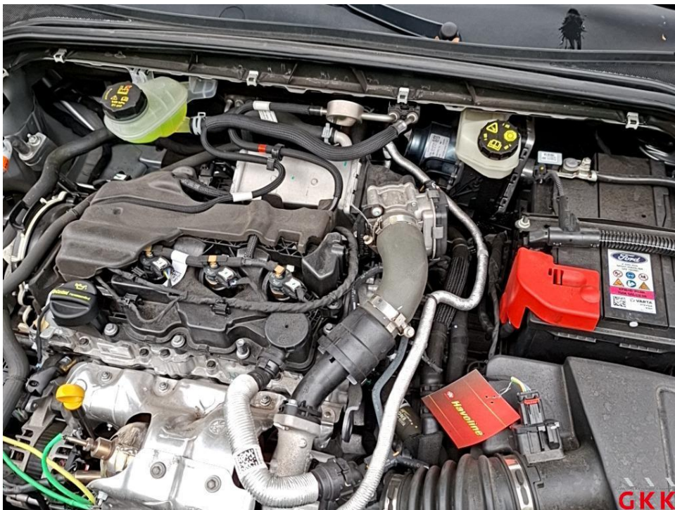
Bild 12. Motor, Ladeluftschlauch, beschädigt, ersetzen
