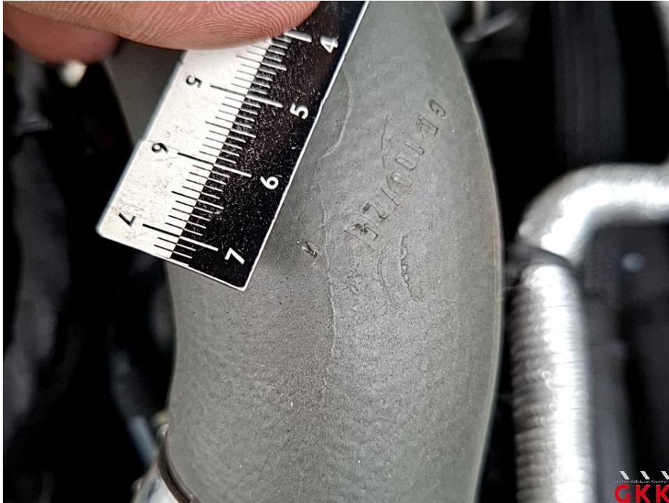
Bild 13. Motor, Ladeluftschlauch, beschädigt, ersetzen
