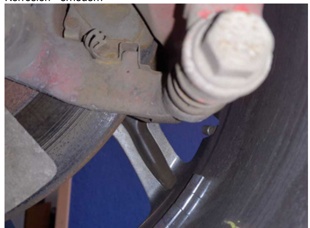
Beschädigung #2: Bremsanlage: Bremsscheiben hinten - Korrosion - erneuern
