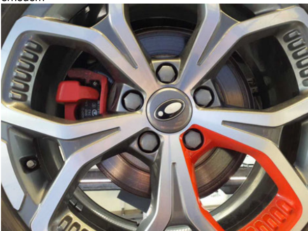
Beschädigung #2: Bremsanlage: Bremsscheiben hinten - Korrosion - erneuern
