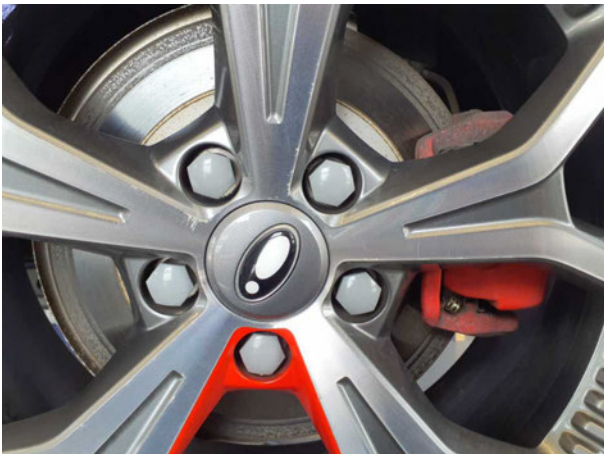
Beschädigung #2: Bremsanlage: Bremsscheiben hinten - Korrosion - erneuern
