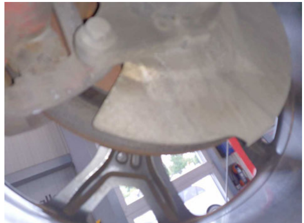
Beschädigung #2: Bremsanlage: Bremsscheiben hinten - Korrosion - erneuern
