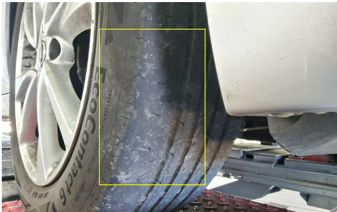
Bild 35 : Achse 1, Reifen Rechts einseitig stark abgefahren
