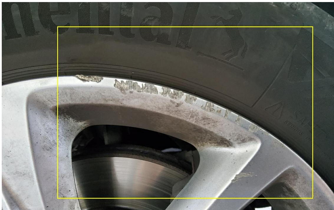
Bild 21 : Leichtmetallrad vorne rechts mehrfach verschrammt
