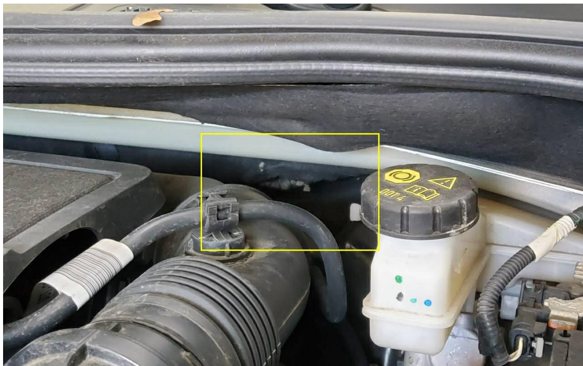
Bild 19 : Motorraum Dämmmatte Spritzwand Tierbiss
