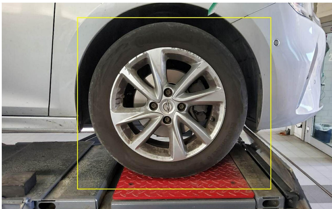
Bild 20 : Leichtmetallrad vorne rechts mehrfach verschrammt
