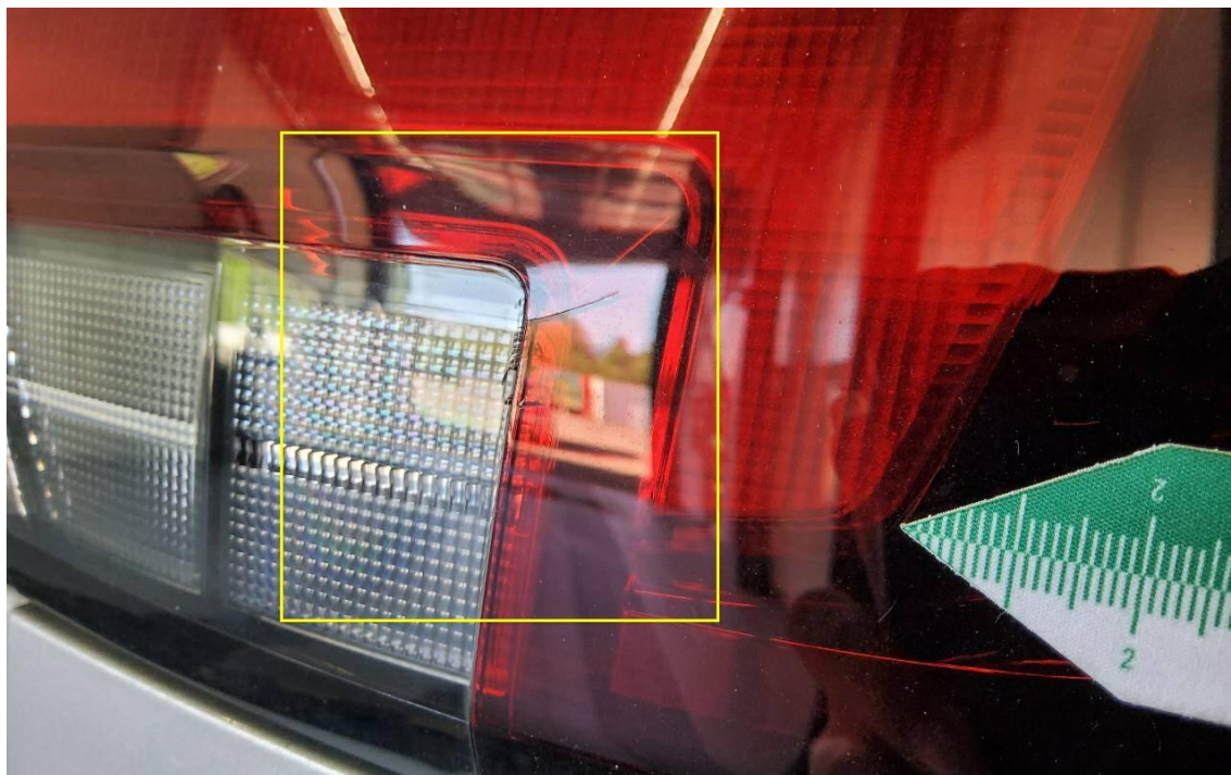
Bild 33 : Rückstrahler rechts außen gebrochen
