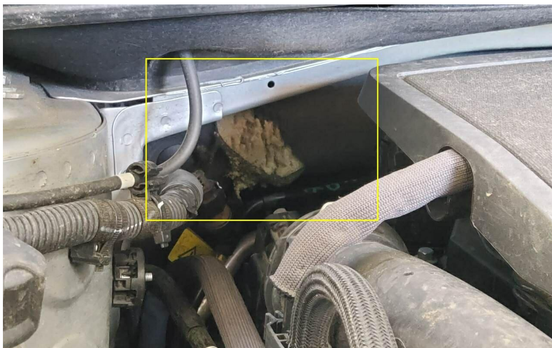
Bild 18 : Motorraum Dämmmatte Spritzwand Tierbiss
