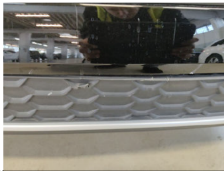
Stoßfängerleiste / Hinten / Kratzer
