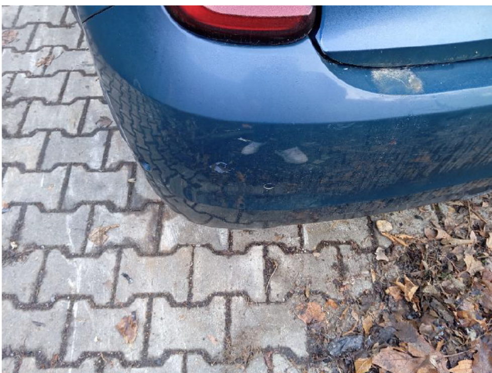
Bild: 46 Altschaden Stoßfänger hinten Lack beschädigt
