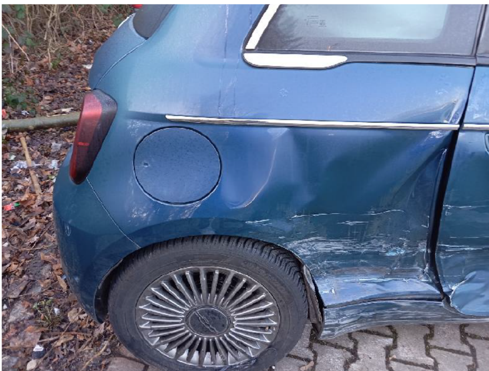
Bild: 27 Seitenwand hinten rechts deformiert
