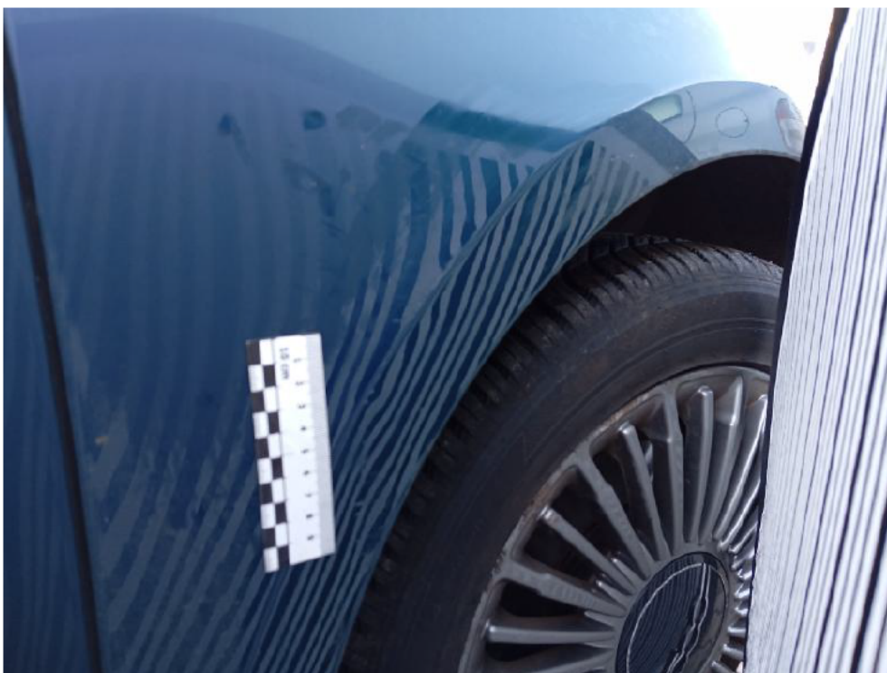
Bild: 23 Kotflügel vorne rechts deformiert
