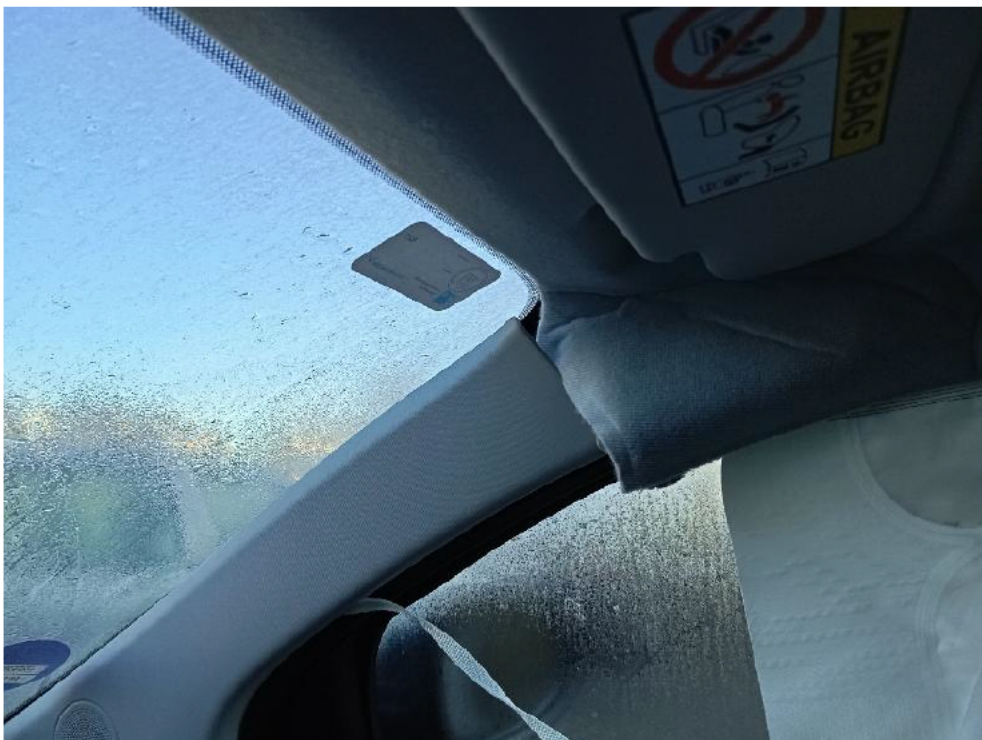
Bild: 40 Innenhimmel deformiert
