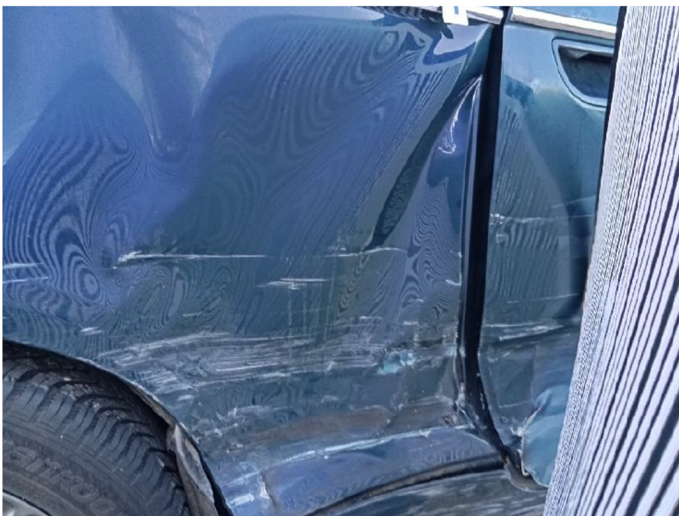
Bild: 28 Seitenwand hinten rechts deformiert
