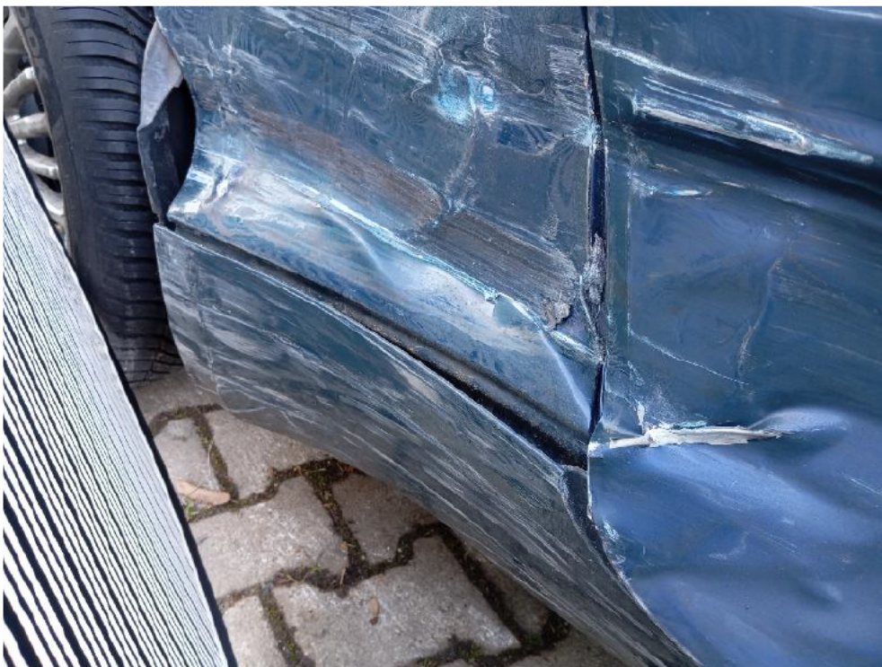
Bild: 32 Seitenwand hinten rechts deformiert
