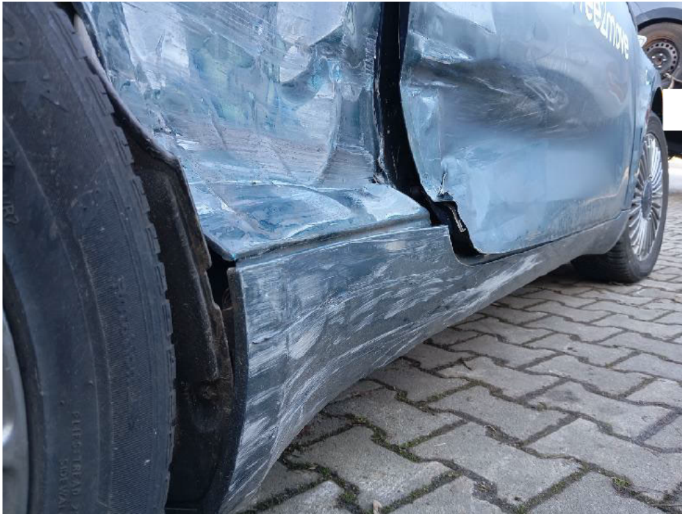
Bild: 35 Schweller rechts deformiert
