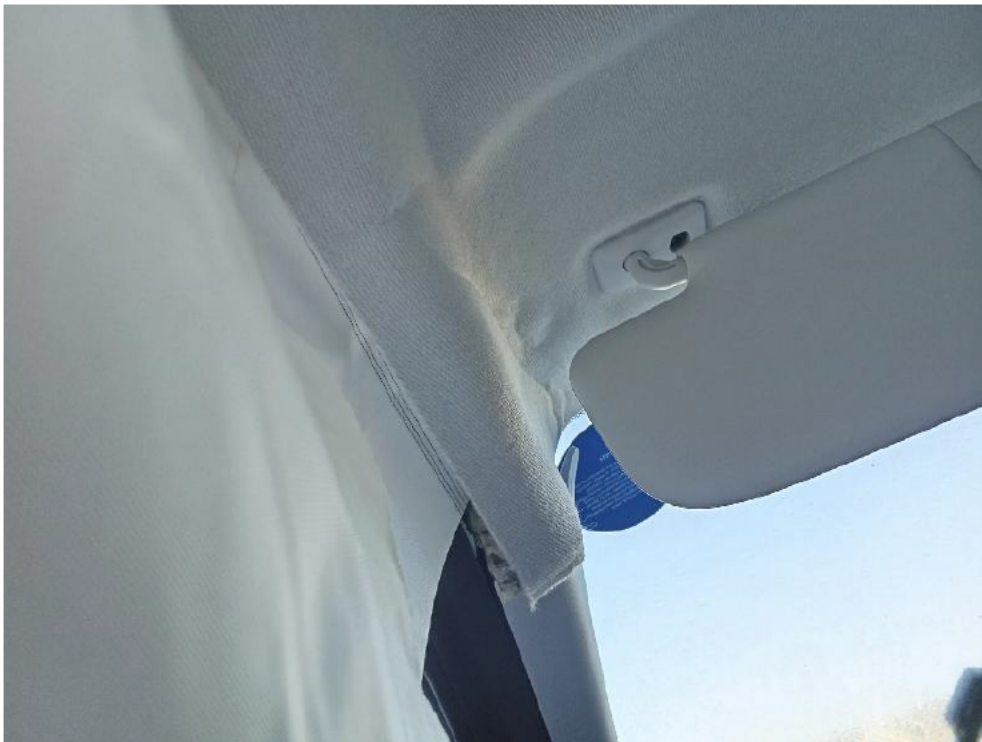
Bild: 41 Innenhimmel deformiert
