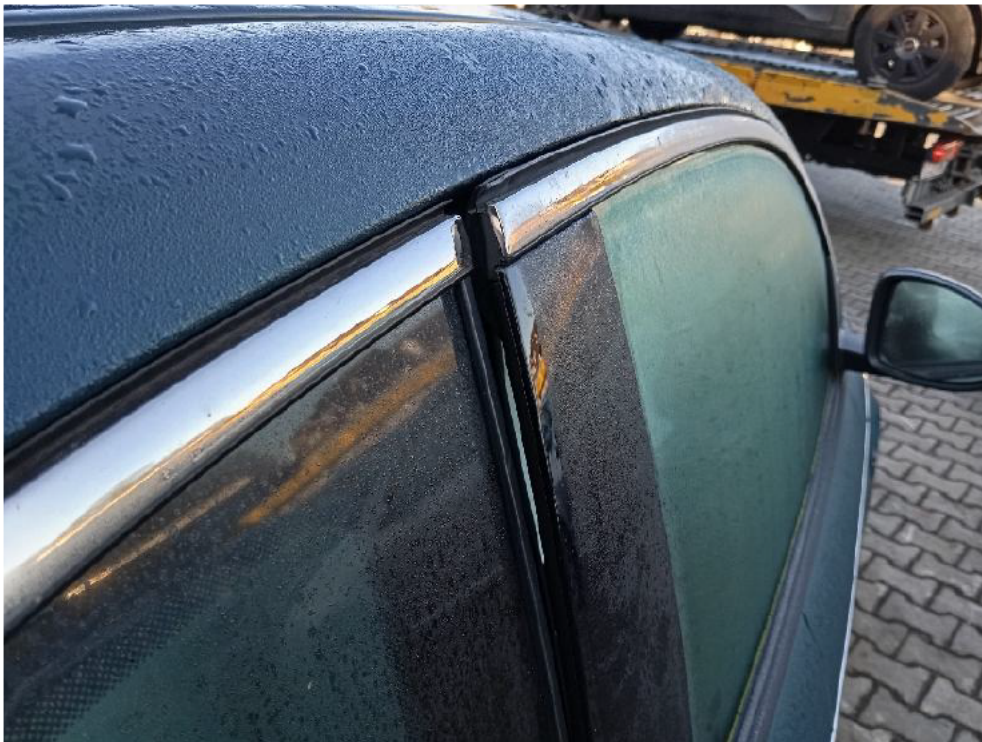
Bild: 25 Tür vorne rechts deformiert
