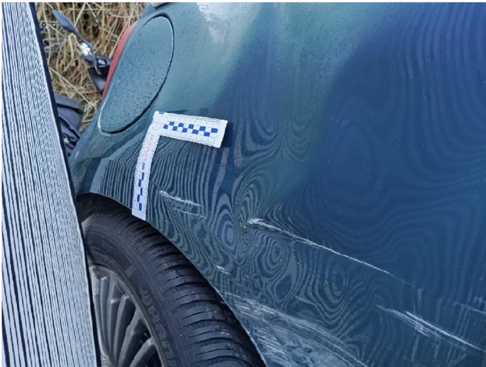
Bild: 31 Seitenwand hinten rechts deformiert
