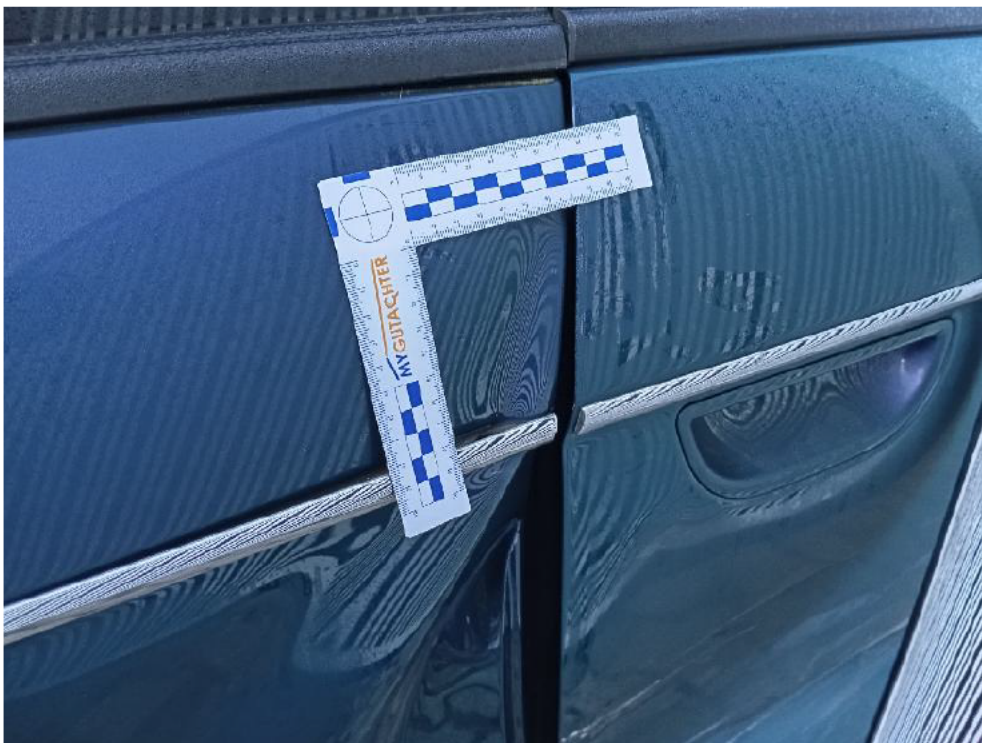
Bild: 30 Seitenwand hinten rechts deformiert
