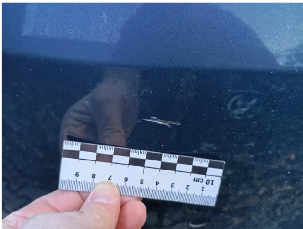
Bild: 47 Altschaden Stoßfänger hinten Lack beschädigt
