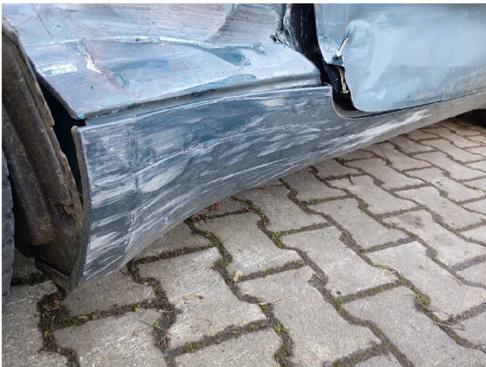
Bild: 34 Schweller rechts deformiert
