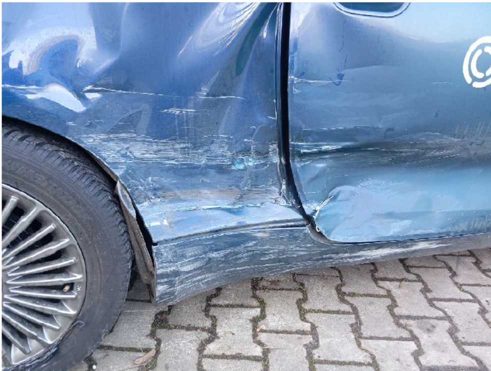
Bild: 33 Schweller rechts deformiert
