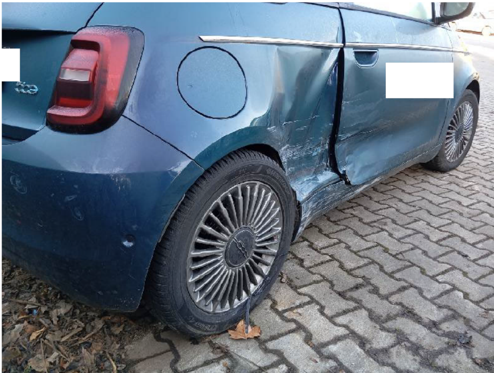
Bild: 11 Übersicht Schadenbereich rechts
