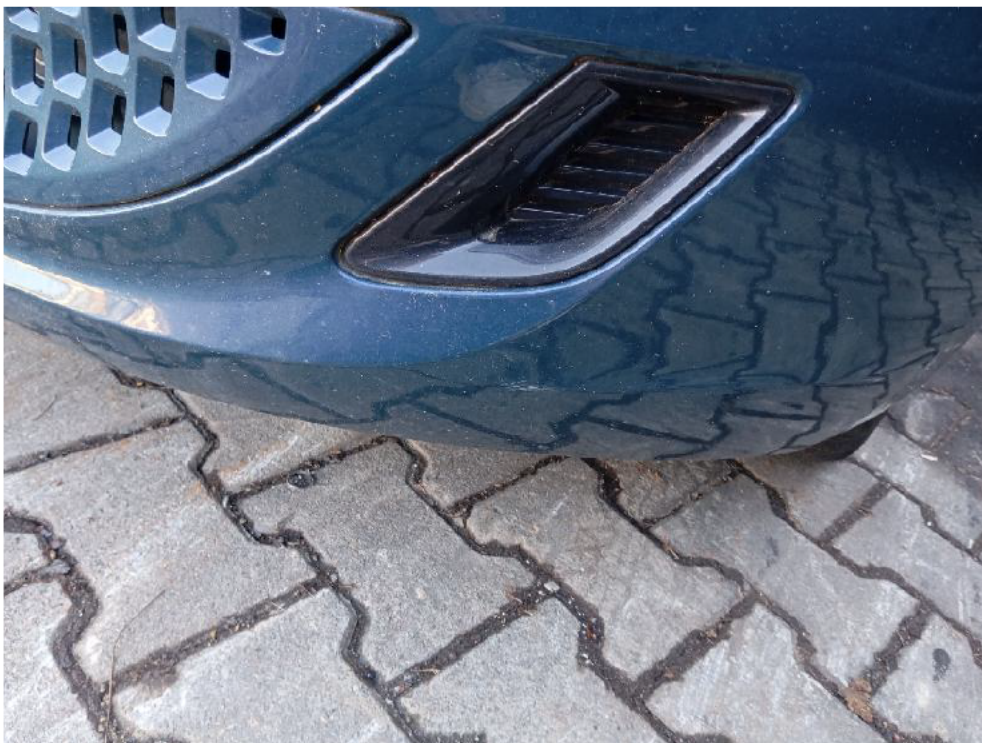
Bild: 44 Altschaden Stoßfänger vorne Lack beschädigt
