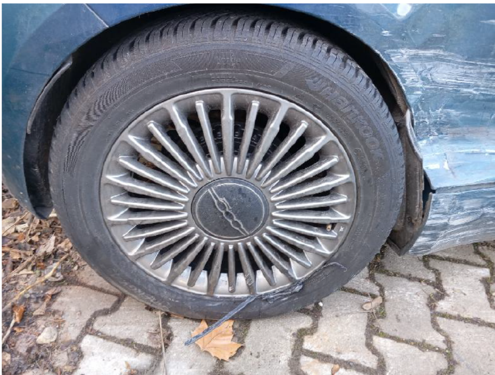
Bild: 36 Rad/Reifen hinten rechts beaufschlagt
