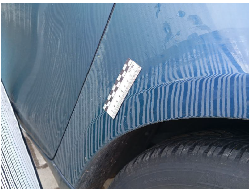
Bild: 22 Kotflügel vorne rechts deformiert
