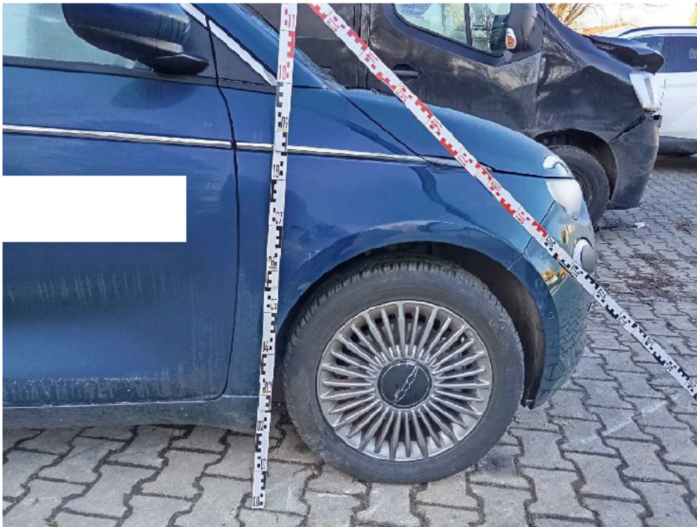
Bild: 13 Übersicht Schadenbereich mit Geometerstab
