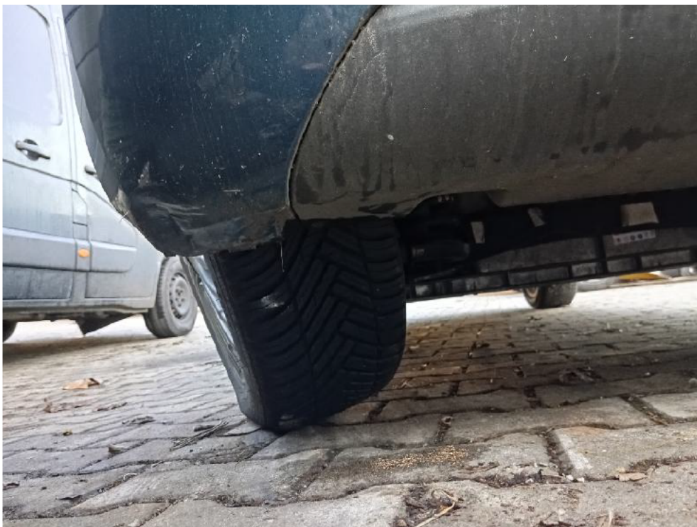
Bild: 18 Achse hinten links deformiert
