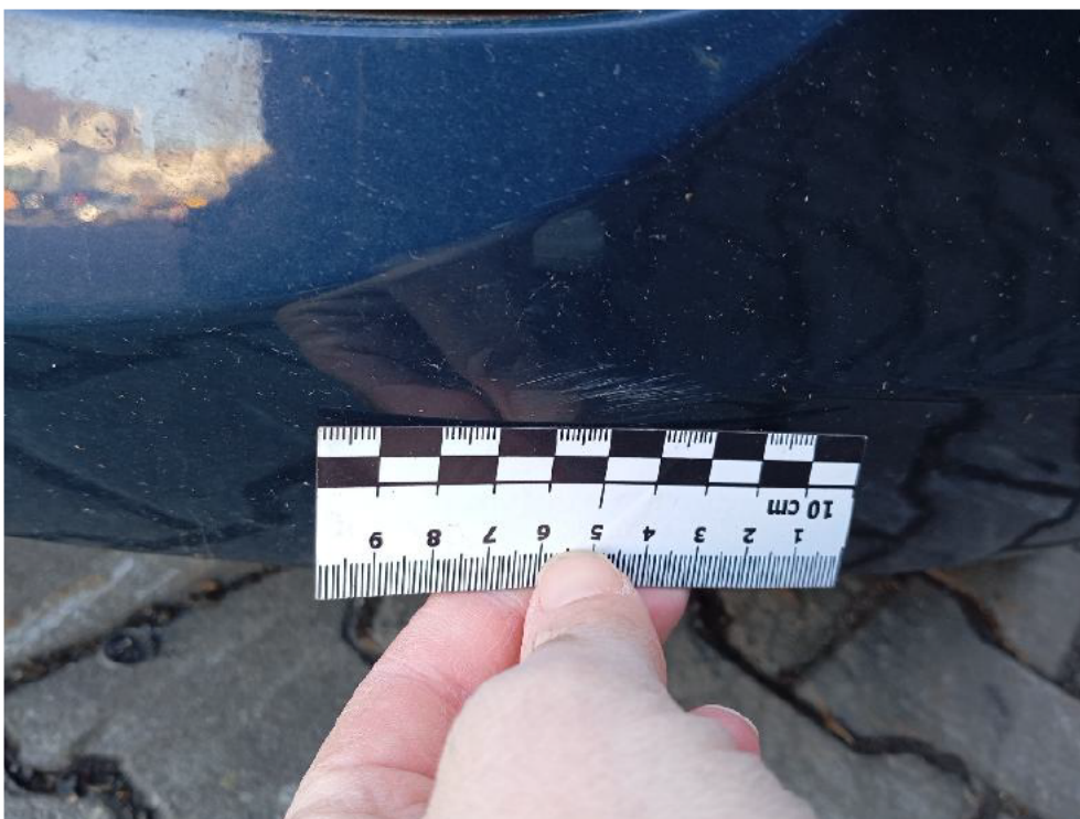
Bild: 45 Altschaden Stoßfänger vorne Lack beschädigt
