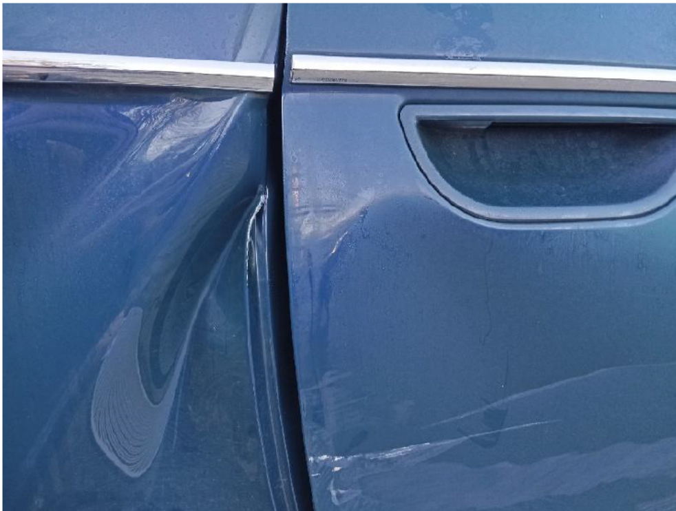
Bild: 29 Seitenwand hinten rechts deformiert
