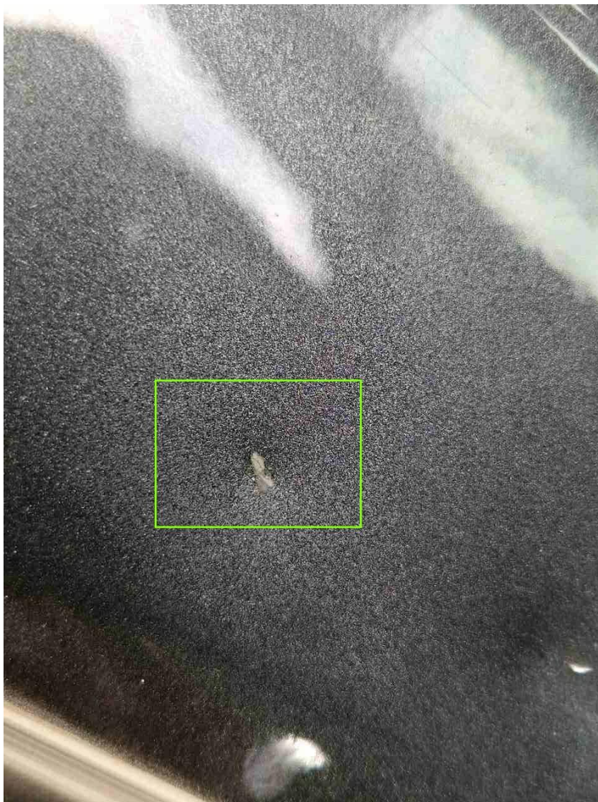
Bild 24 : Türeinstieg hinten rechts Dellen
