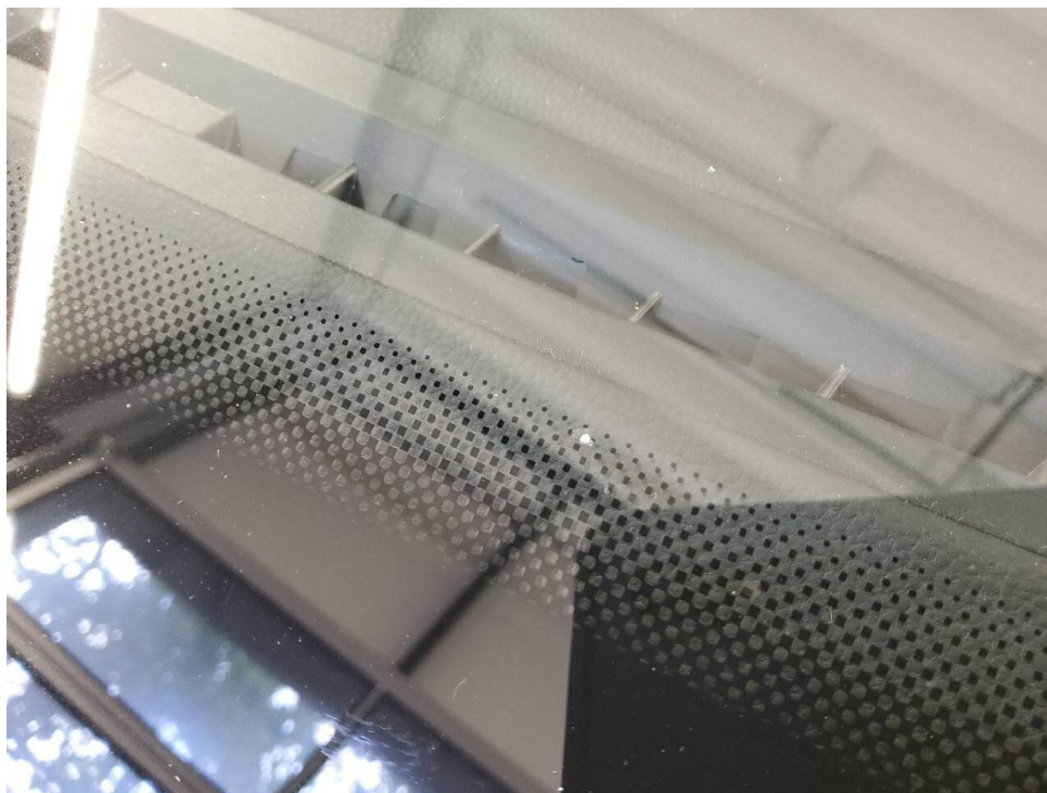
Bild 1 : Windschutzscheibe oberflächliche Steinschläge
